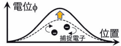
図1 静電波動に捕捉された電子の往復運動
