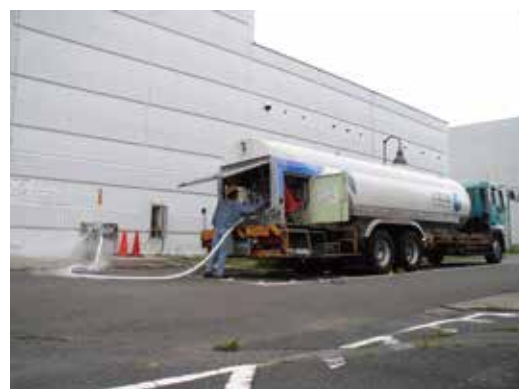
超伝導コイルを冷やすためのマイナス196°Cの液体窒素を運ぶタンクローリー
