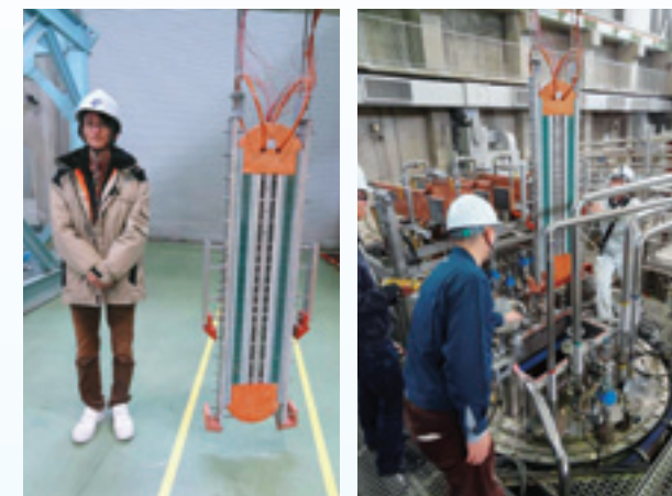
図3 左:大型高温超伝導導体サンプルと総研大生の寺崎義朗君、右:核融合科学研究所超伝導マグネット研究棟の大型導体試験設備へのサンプル装着の様子。
