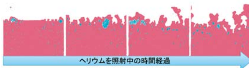
図4：ヘリウムの気泡の形成から繊維状の構造が生えるまでを再現したMD-MCハイブリッドシミュレーション。赤色及び水色の部分はそれぞれタングステン及びヘリウムが存在している領域を表しています。
