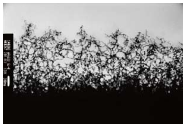
図2：ヘリウムプラズマの照射によって生えた繊維状のタングステン。 画像提供：名古屋大学 梶田信准教授 九州大学 吉田直亮名誉教授。
