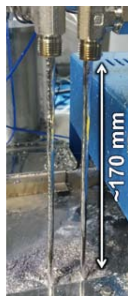
図5 溶かしたハンダを用いた噴流実験の様子。噴流の安定化のため、噴流内にボールチェーンを入れています。
