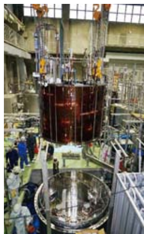
図2 CSモジュールコイルの試験クライオスタットへの組み込み作業
