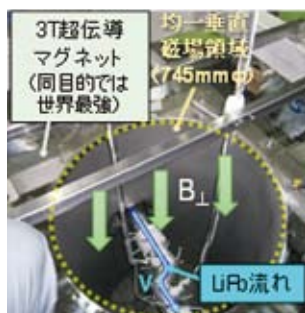
図3 熱・物質流動ループ装置Orosshi-2を用い、流動直交磁場としては世界最強の3テスラの均一磁場下での液体リチウム鉛のMHD圧力損失測定に成功しました。
