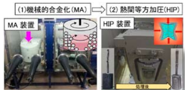
図5 分散強化銅の製造プロセス
