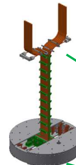
大口径高磁場導体試験装置 ( -250^{\circ}\text{C} 、磁場 13 テスラ)
