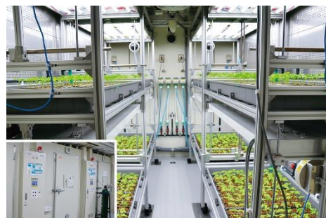
植物環境制御システム（ネットワークカメラにより遠隔地からの長期環境応答モニタリングが可能）
