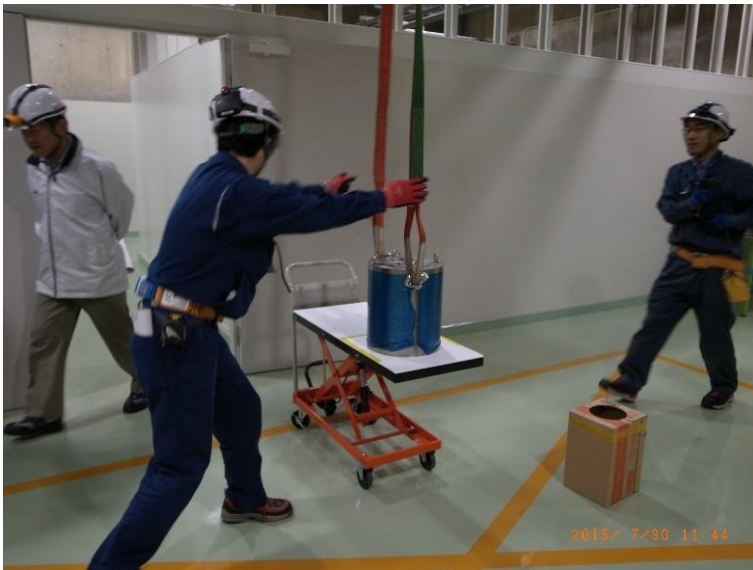
線源容器を保管場所から本体室へ移動させる試験
