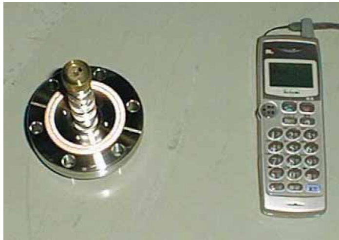
図 3.6.5-7 小型高速中性粒子分析器：ダイヤモンド検出器の全体写真。
