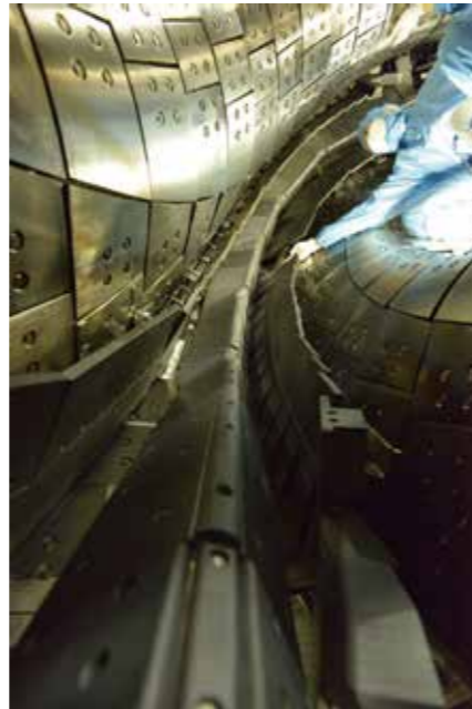
LHD 真空容器内のダイバータ。三角屋根構造の裏側に高性能化された真空ポンプが設置されています。
