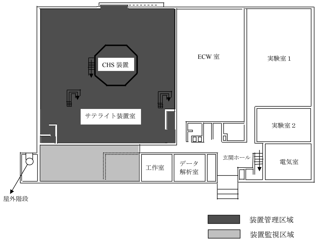
図 1-3-4 開発実験棟の装置管理区域と装置監視区域 (2008年6月末現在) (2008年7月1日付けのCHS廃止にともない管理区域を廃止)
