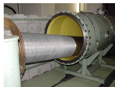
図 9 崩壊した加速器 加速器タンクを開けた時の状態。加速器本体を支える絶縁コラムの接着面が破断し、ポッキリ折れた状態でターミナルシェルが加速器タンクに接触している。
