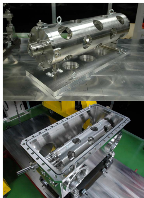
図3. 共振器本体（上）と真空チェンバーに組み込まれた実器(下)
