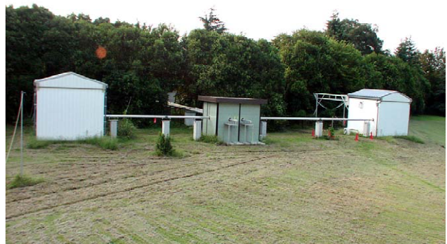
図2. MIRA-1.2 30m基線干渉計
