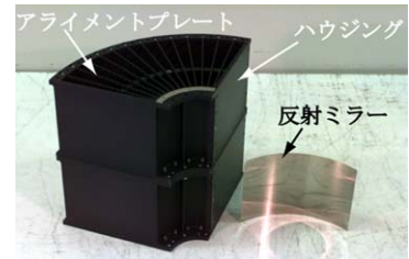
図 2. ハウジング内のアライメントプレートと反射ミラー
