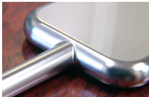
図4. タイプ1型ペーンの曲面加工
