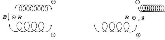
図 2.2 電場および加速度による案内中心のドリフト運動 (概念図).
