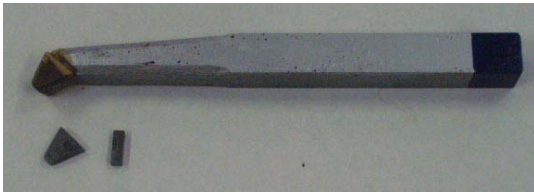
写真2 超硬ロー付け溶接バイト&チップ
