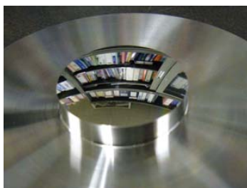
図 5 SUS304 の超精密切削
