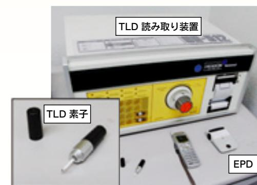
図2 TLD素子と読み取り装置、EPDの概観
