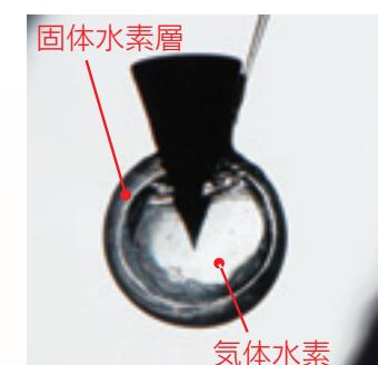
図2(c) 形成された固体水素層。その中には薄い気体水素が満たされています。
