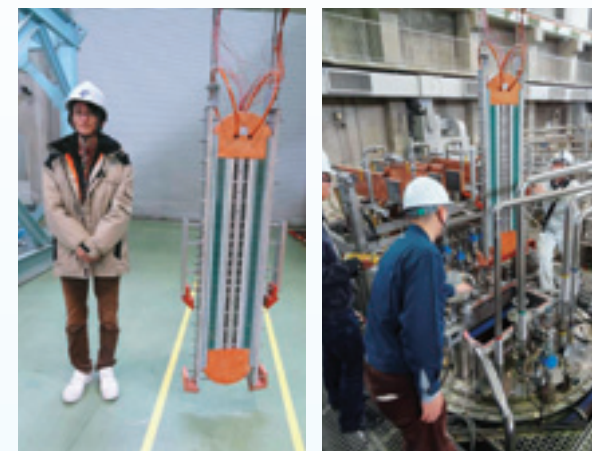
図3 左: 大型高温超伝導導体サンプルと総研大生の寺崎義朗君、右: 核融合科学研究所超伝導マグネット研究棟の大型導体試験設備へのサンプル装着の様子。
