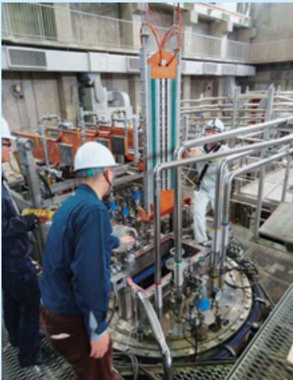
大型高温超伝導体サンプルの試験の様子 (本誌、研究最前線「ヘリカル型核融合炉用超伝導コイルの革新的製作方法—高温超伝導体とその接続部の開発—」より)
