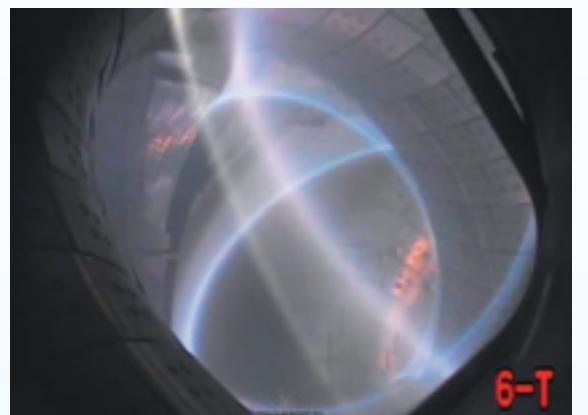
図1 平成25年12月3日にイオン温度9,400万度を記録したプラズマ。目に見えない磁場によって容器壁から浮かせてプラズマを閉じ込めています。
