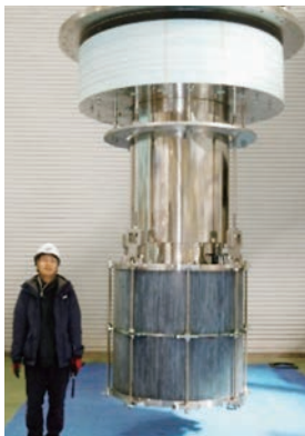
図4 直径 70 センチメートルの大空間に 13 テスラの高磁場を発生する試験設備
