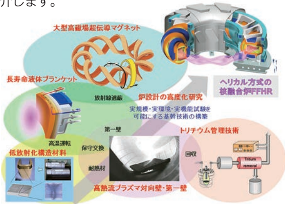
図3 核融合炉を設計するために核融合工学研究プロジェクトで行われている工学実験研究
