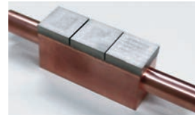
図6 タングステンと酸化物分散強化銅 (ODS-Cu) との接合に BNi-6 ロウ材を用いて製作したダイバータ試験体
