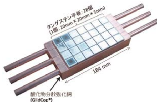
図6 タングステンと銅合金をろう付け接合した大型ダイバータ試験体
