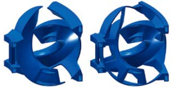
図4 トポロジー最適化を適用して得られたコイル支持構造物の形状（右図）。左図は従来の設計手法によるもので、これらの形状を円周方向に10個並べるとドーナツのような全体形状になります。これまでの設計では全体で7,800トンだった重量が、トポロジー最適化によって約2,000トン低減できました。
