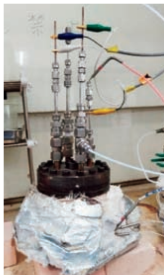
図3 フッ化水素を入れた溶融塩による低放射化フェライト鋼の腐食試験を行う装置
