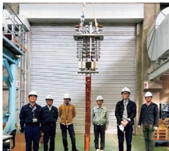
図6 大電流大型高温超伝導導体（STARS）で構成した試験用サンプル。大型超伝導導体試験装置に組み込む前に実験スタッフと一緒に集合写真。
