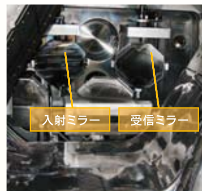
図2 プラズマ側から見たLHD真空容器内の協同トムソン散乱計測に用いる入射・受信ミラー。
