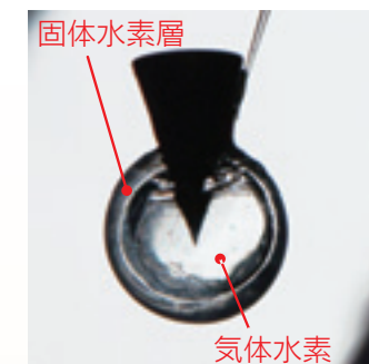
図2(c) 形成された固体水素層。その中には薄い気体水素が満たされています。
