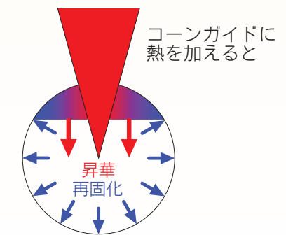
図2(b) 昇華-再固化の模式図
