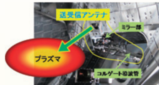
図2 真空容器内部に設置したドップラー反射計用アンテナの写真。複数枚の金属ミラーを用いた伝送光学システムで構築しています。ミラー部までは、コルゲート導波管という細かい溝のついた金属管の中を通して、ミリ波を伝送しています。金属バネを用いた回転機構によって真空容器の外側からミラーを動かすことにより、電磁波の入射方向を変化させることができます。
