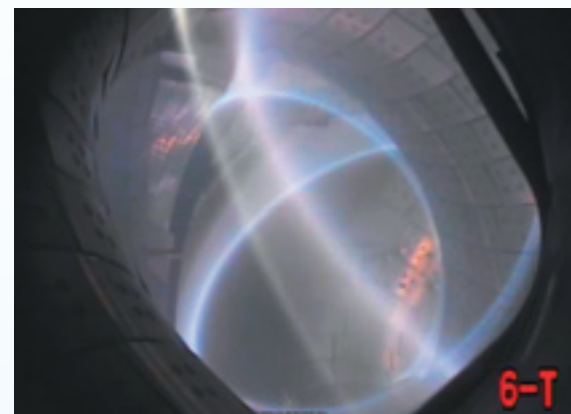
図1 平成25年12月3日にイオン温度9,400万度を記録したプラズマ。目に見えない磁場によって容器壁から浮かせてプラズマを閉じ込めています。
