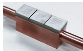
図6 タングステンと酸化物分散強化銅 (ODS-Cu) との接合に BNi-6 ロウ材を用いて製作したダイバータ試験体
