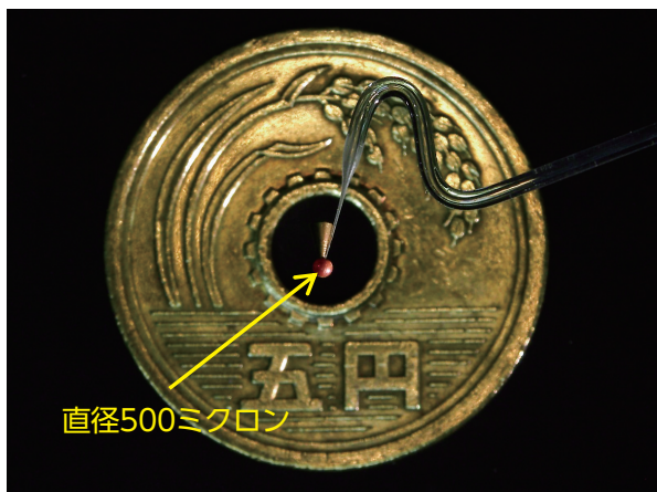
図1 レーザー核融合実験に使用するターゲット(5円玉との比較)。
