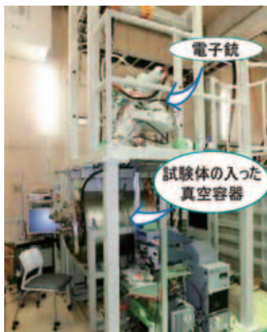
図1 ACT2の装置写真。上部に電子銃があり、下部に試験体が入った真空容器があります。写真には入っていませんが、他にも各種計測機器や冷却水配管がつながっています。
