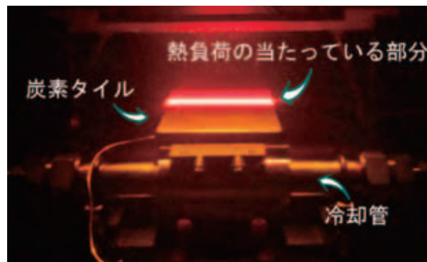
図2 ACT2を使ってLHDでの熱負荷を模擬した実験の際の写真。中央の手前から奥に伸びるのが炭素のタイルで、熱負荷の当たっている部分が赤熱しています。上部から電子ビームによって加熱していますが、電子は目に見えないので、実験中は材料がひとりてに光りだすように見えます。
