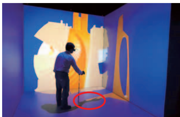
図2：原型炉の設計データを、CompleXcopeを用いてVR空間に投影している様子。自分自身が原型炉の中に入って歩いたり、視点をいろいろと変えたりすることができる。また、VR空間の中に投影された自分自身の「手」（床面スクリーン上の赤で囲まれたところに手が映っている。操作者には自分の「手」は浮かんで見える）で部品をつかんで動かしている。
