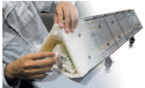
図6 3次元CADのデータをもとに3Dプリンターで製作した改良型クライオポンプの模型
