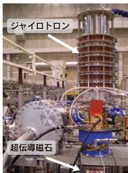
図2. LHDの加熱実験用として設置されたジャイロトロンシステム
