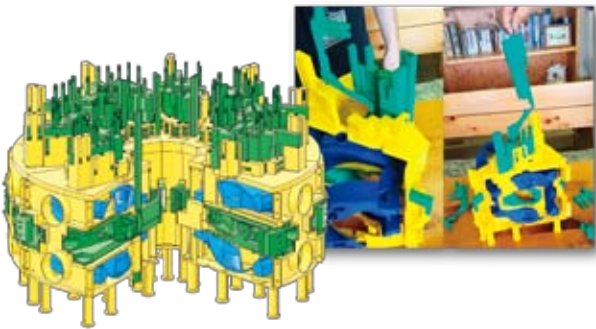
図1 ヘリカル型核融合炉FFHR-c1のブランケット交換検討の例（カートリッジ型）。
