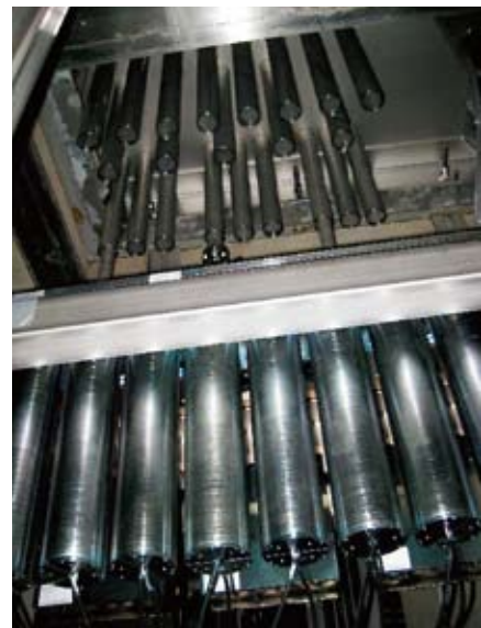
図4 実験室地階天井部に設置された垂直中性子カメラ
