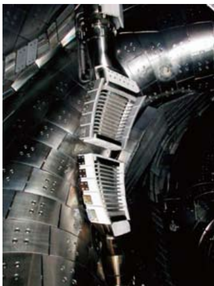
図1 FAITアンテナ。上下二つのアンテナから電磁波を放射する。
