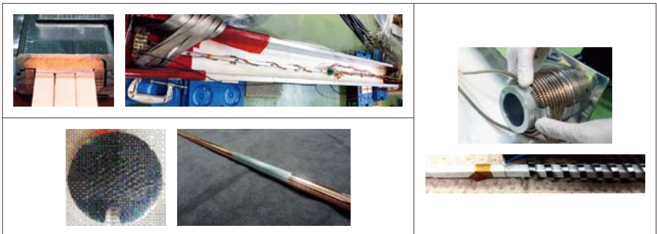
図5 次世代ヘリカル装置への適用を目指して開発されている3種類の高温超伝導導体サンプル。左上：STARS導体（端部断面とサンプル全体）、左下：FAIR導体（端部断面とサンプル全体）、右：WISE導体（小型コイル巻線の様子と直線形状短尺導体端部）。
