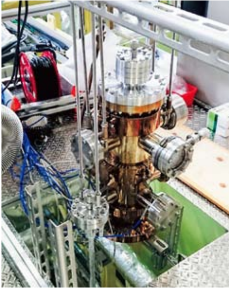
図3 液体金属（リチウム鉛）からの高効率・水素燃料連続回収装置（京都大学との共同研究）。
