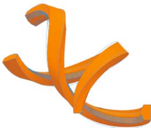
図1 ヘリカル核融合炉のヘリカルコイル巻線形状の比較。青色点線がLHDと同じねじり方に基づく形状、橙色で描かれたものが変更後の形状。
