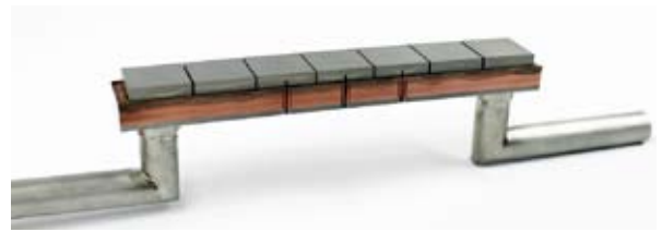
図4 タングステン、酸化物分散強化銅、ステンレス鋼を先進的ろう付接合法で接合したダイバータ受熱機器試験体。
