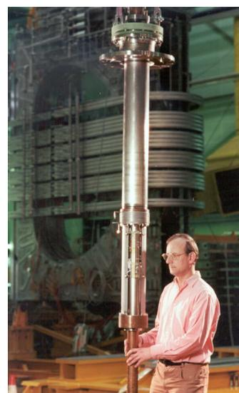
図 2-5 20kA 高温超伝導電流リード全体写真
