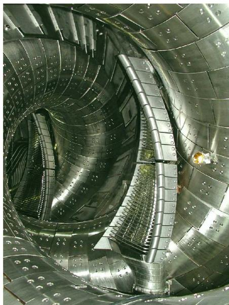
図 3.1.2-1 LHD のプラズマ真空容器内に設置された高周波アンテナ
