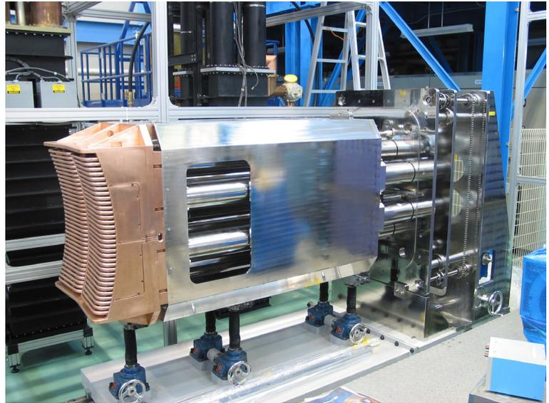
図 1 KSTAR 用プロトタイプアンテナ
