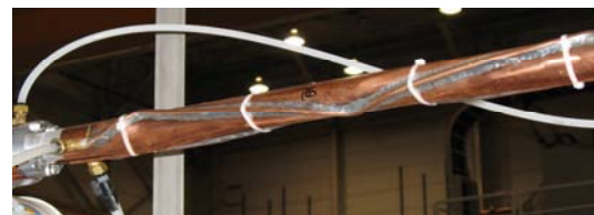
図 3.3.2-3-4 導波管冷却の強化
