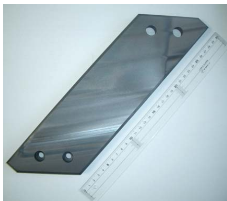
図 2.3.3.1-1 LHD で使用されたダイバータ・タイル
