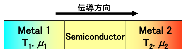
図 3. 3. 1. 3-3 金属-半導体-金属接合の模式図
