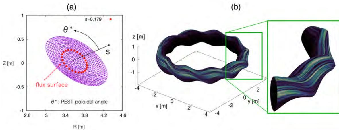
図 3.3.5.4-1 (a) : 直線磁気座標に基づいて生成した LHD 炉心領域の非構造格子の例。 $s$  はフラックスラベル、 $\theta^*$  はポロイダル角を表す。(b) : LHD 炉心領域におけるイオン温度勾配不安定性の線形成長に関するシミュレーション例。カラーマップは静電ポテンシャルの大きさを表す。
