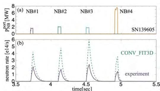
図 3.2.2.1-3 中性粒子ビームの入射パワー（上図）と中性子発生率（下図）の時間変化。下図の実線が計測結果で点線がCONV\_FIT3Dによる計算結果である。（参考文献[3.2.2.1-2]より転載）
