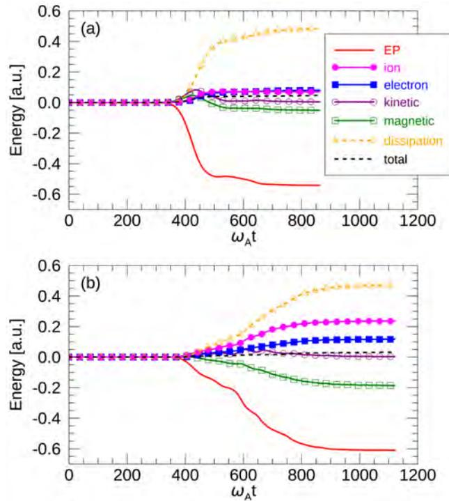
図 3.3.3.1-1 バルクプラズマベータ値が (a)1%と (b)4%の場合の、高エネルギー粒子、熱イオン、電子、MHD 運動エネルギー、磁場、散逸の各エネルギーの時間発展。全エネルギーの時間発展も示されている。
