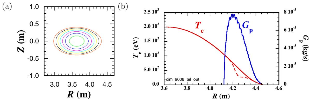
図 3.3.1.10-1 (a) 磁気島がない配位における横長ポロイダル断面。(b) ペレット溶発率  $G_p$  (青線) と電子温度  $T_e$  (赤線)。実線は初期温度、破線はペレット消滅後の温度を示す。
