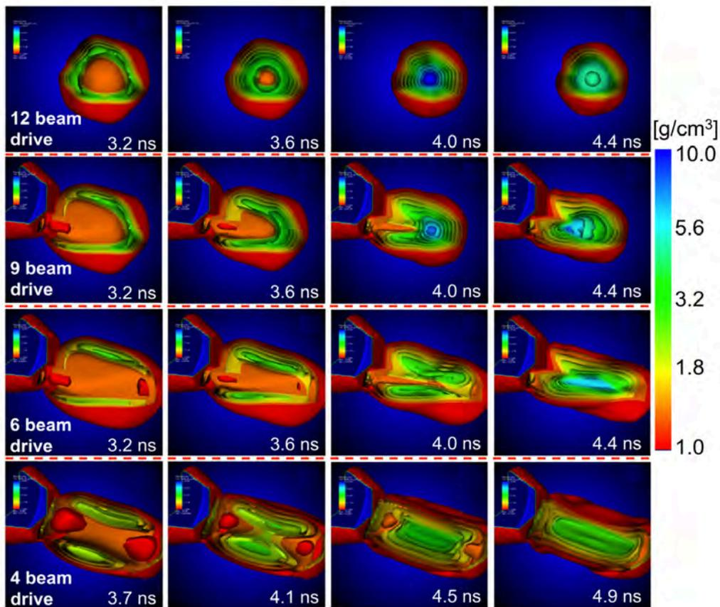
図 4.3.1-2 3次元流体シミュレーションコード IMPACT-3D によって計算された非対称爆縮によるコア形成の比較 [参考文献: H. Sawada and H. Sakagami, “Numerical study of core formation of asymmetrically driven cone-guided targets”, Physics of Plasma, Vol. 24 (2017) pp. 100703(1 ~ 6).]
