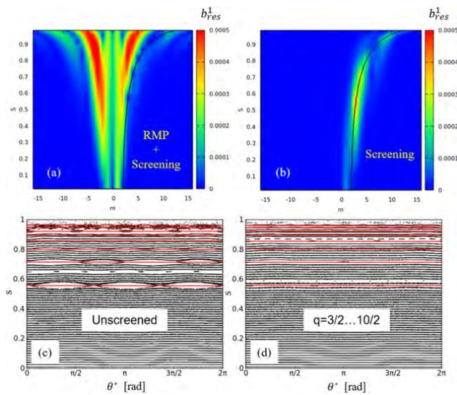
図 4.3.3-2 EAST トカマクにおける磁力線構造。図はそれぞれ、(a) プラズマ応答を含んだ RMP のポロイダルハーモニクス、(b) プラズマ応答のみのポロイダルハーモニクス、(c) プラズマ応答を含まない場合の磁力線構造、(d) プラズマ応答を含んだ場合の磁力線構造、を示す。 [4.3.3-4]。
