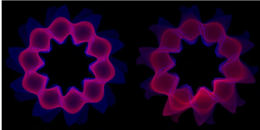
図 3.3.4-1 装置上部から見たプラズマの発光分布。左右はそれぞれネオン及び窒素ガス放電であり、不純物発光を赤、水素発光を青で可視化している。
