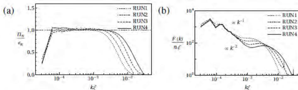
図 4.1.3.10-1 Gros-Pitaevskii 方程式による量子乱流 DNS における、(a) 粒子数密度散逸率  $\epsilon$ 、及び粒子数散逸係数  $\nu$  を用いて規格化された粒子数密度フラックス  $\Pi_n(k)/\epsilon$  と、(b) エネルギースペクトル  $F(k)$  ([4.1.3.10-1] Fig.2)。エネルギースペクトルの傾きを示す線は、 $k^{-1}$  及び  $k^{-2}$  に比例。ただし、記号  $k$  は波数。
