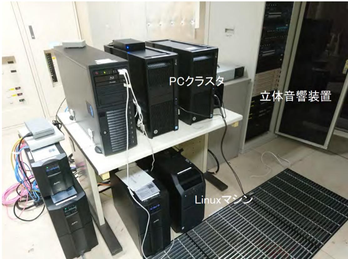
図 2.3.2-1 CompleXscope のコンピュータシステム。机の上に乗っている 3 台のマシンのうち、右 2 台が PC クラスタであり、左 1 台が旧 Linux マシンである。机の下の右が Linux マシンであり、左が UPS である。奥の機械が立体音響装置である。
