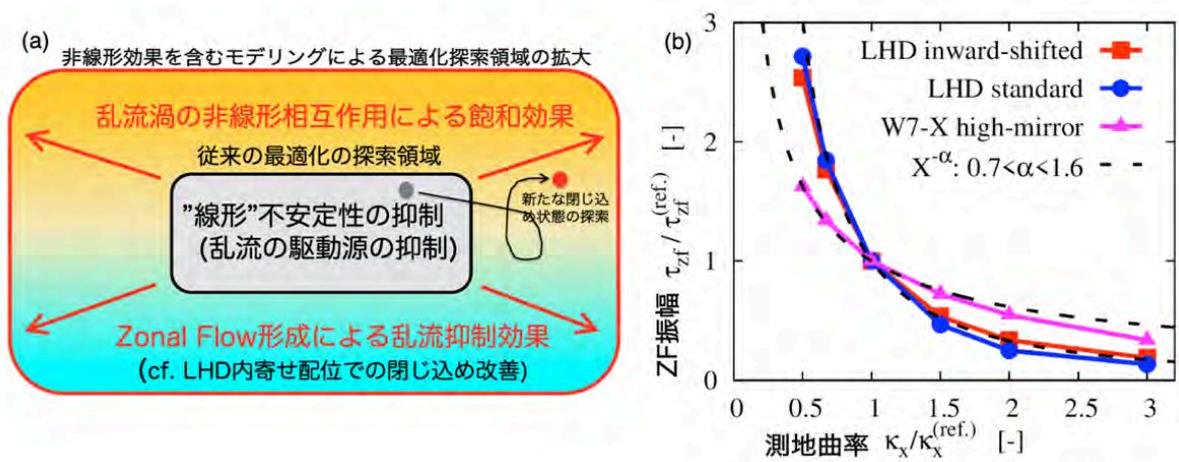
図 6.2.2-1 (a) 非線形効果を含むモデリングによる最適化領域拡大の概念図。(b) ゾーナルフロー強度の磁場形状依存性
