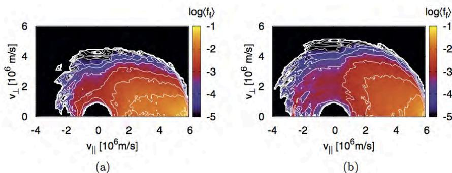
図 3.3.3.3-1 LHD における接線 NBI 高速イオンの規格化小半径  $\rho = 0.2$  における 2 次元速度空間分布関数。(a) 実効電荷 1.5 (b) 実効電荷 3.36 の場合。実効電荷が増加とともに、エネルギーの高いイオンのピッチ角散乱が増加している ([3.3.3.3-1] より転載)。
