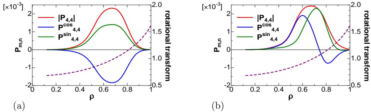
図 3.3.1.3-2 Boozer 座標上での摂動圧力の支配的成分のモード構造。(a) フローなしの場合、(b) 実験値の 30 倍のフローが存在する場合、
