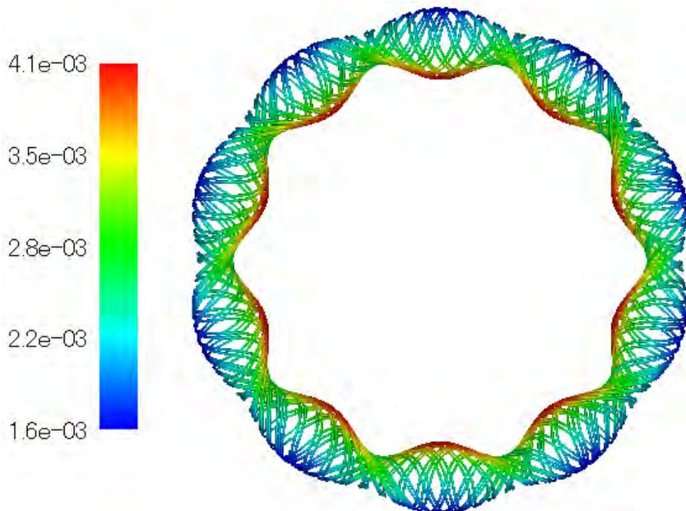
図 3.2.1.2-1 実験データに基づいて計算した三次元フローの流線図
