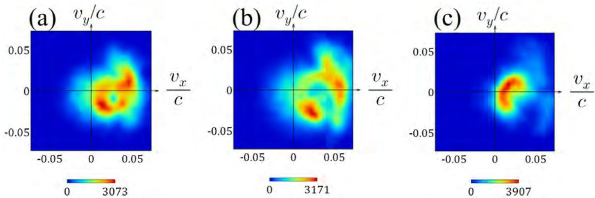
図 3.3.5.6-2 リコネクション下流において形成されているイオンの速度分布関数。(a) 円環状の構造が見え、イオンは実効的に加熱されていることが分かる。(b) リコネクション磁場を強くした場合、半径が大きい円環状構造が形成された。(c) ガイド磁場を強くすると、円の一部が欠けている、円弧状の構造が形成された。
