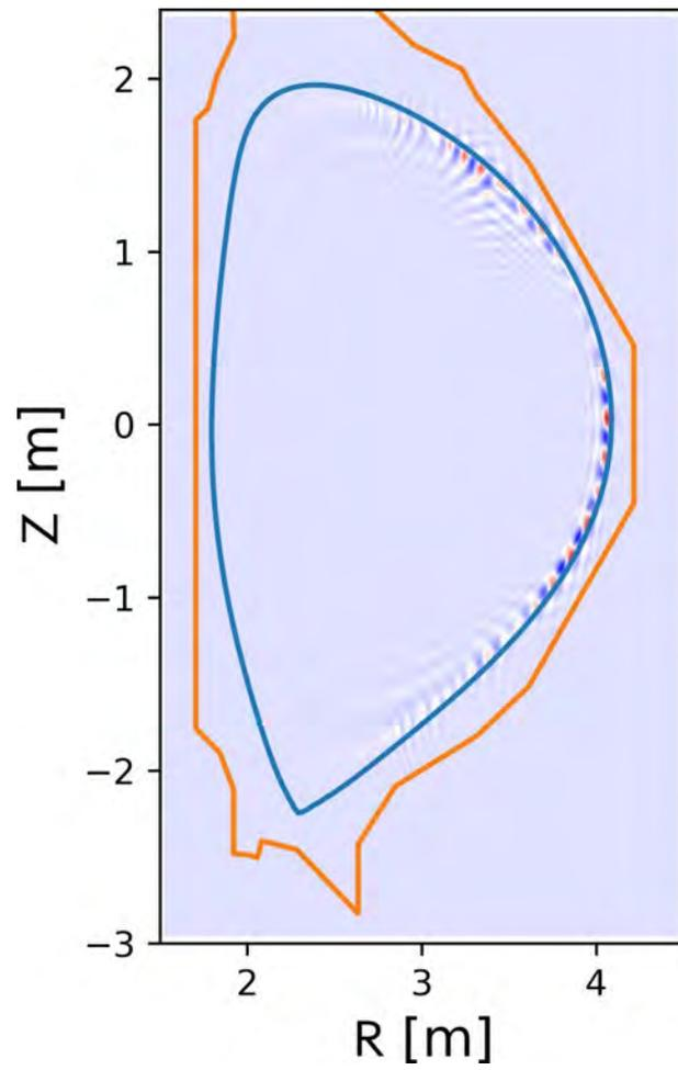
図 4.4.3-1 MIPSでELMのシミュレーションで得られた圧力摂動。プラズマ周辺部に局在化したモード構造が表れている。
