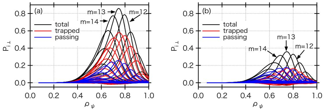
図 3.3.1.6-1 (a) 曲率ドリフトと磁場勾配ドリフトを無視した場合と (b) 両ドリフトを考慮した場合の磁場に垂直方向のイオン圧力の揺動成分の径分布。赤線は補足イオンからの寄与分、青線は通過イオンからの寄与分、黒は両方の寄与を合わせた分布である。各モードの振幅は、電子圧力揺動の  $(m,n)=(13,10)$  の最大振幅で規格化している。
