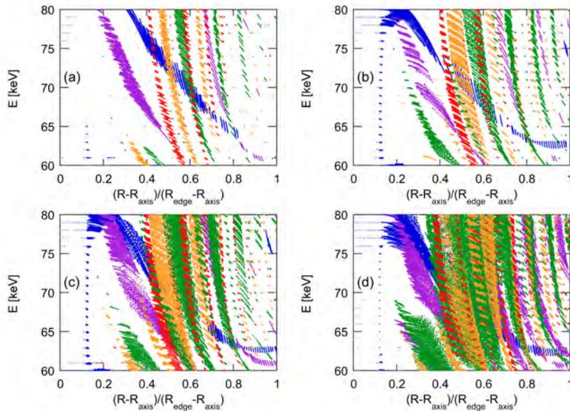
図 3.3.3.1-2 NBI 吸収パワーが (a) 1.56MW, (b) 3.13MW, (c) 6.25MW, (d) 15.6MW の場合の、高速イオン位相空間構造。五つのアルフベン固有モード (AE) を考慮し、単独の AE が存在する状況で高速イオン軌道を追跡した。AE によって捕捉された粒子が赤道面を通過する際の規格化大半径 (横軸) と運動エネルギー (縦軸) を記録した。色は AE を表している。NBI 吸収パワーが上昇するとともに、AE の振幅が大きくなるので共鳴領域が拡大する。複数の共鳴領域が重なった場所では粒子軌道が統計的になり、輸送が急激に増加する。 [3.3.3.1-4]
