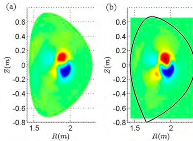
図 4.3.3-1 EASTトカマクにおけるトロイダルアルフベン固有モードのトロイダル電場に関する (a) M3D-Kコードと (b) MEGAコードの比較。トロイダルモード数は $n=1$ である。両者がよく一致していることが確認できる [4.3.3-3]。
