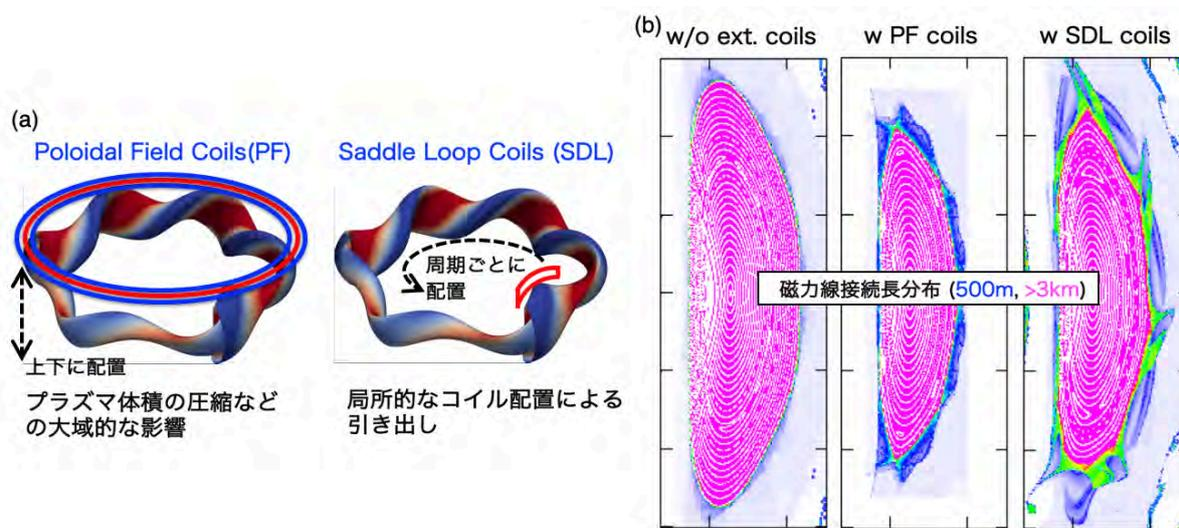
図 6.2.3-1 (a) ダイバータレッグ引き出しのための外部コイル配置。(b) 磁気線構造の比較
