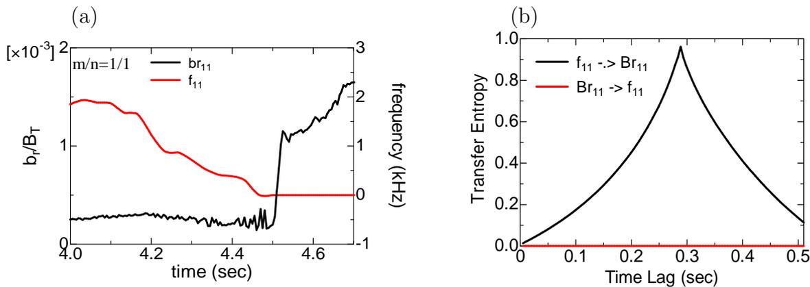
図 3.3.1.8-1 (a) 電流駆動放電における、 $m = 1/n = 1$  成分の摂動磁場  $br_{11}$  (黒) と、その回転周波数  $f_{11}$  (赤) の観測データ。(b)  $br_{11}$  と  $f_{11}$  との間の transfer entropy。
