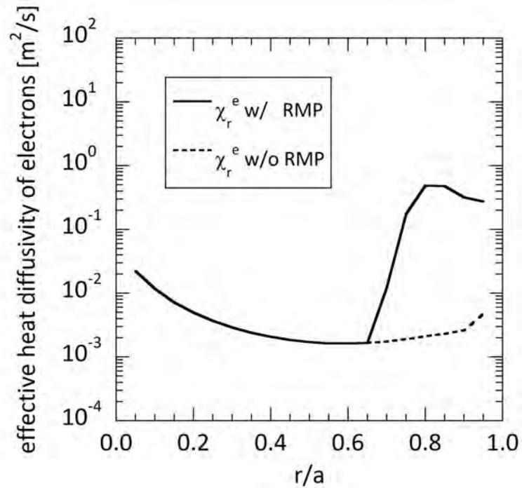
図 3.3.2.9-1 円形トカマク磁場の  $0.6 < r/a < 1.0$  の領域に RMP を加え、その領域のみ磁力線構造をストカスティックにした場合、径方向の電子熱拡散係数  $\chi_r^e$  (実線) は、 $0.6 < r/a < 1.0$  において新古典熱拡散係数 (破線) と比べ大きな値になるが、R-R 理論値  $\chi_r^{RR}$  と比べるとかけ離れて小さい [3.3.2.9-1]。ここで、 $r/a = 0.8$  において、 $\chi_r^e/\chi_r^{RR} \lesssim 10^{-6}$  であった。また、 $r/a = 0.8$  における衝突頻度は、 $\nu^* \approx 0.1$  である。
