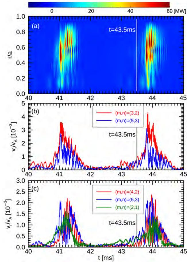
図 3.3.3.1-3 (a) AEによる高速イオン輸送束分布、(b) 主要な二つのAEのMHD速度揺動、(c) (b)以外のAEのMHD速度揺動のそれぞれの時間発展。 [3.3.3.1-5]
