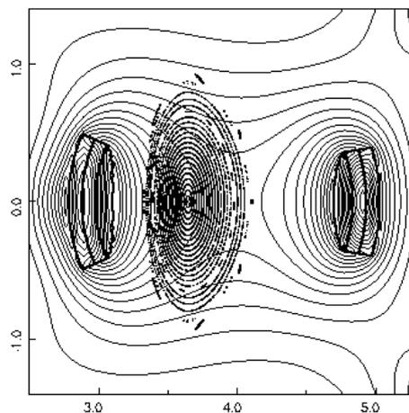
図 3.3.1.9-2 真空磁気軸位置  $R_{ax}=3.6\text{m}$ ,  $\gamma_c=1.254$  での LHD 真空磁場のポアンカレプロット。D shape coil 電流が (a) 無しと (b) 有りの場合、
