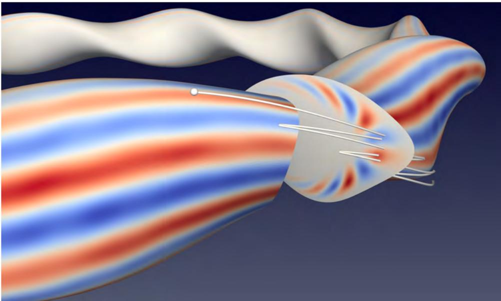
図 3.3.1.6-2 LHD における典型的な捕捉イオンの軌道と、抗性バレーニングモードによる電子圧力の揺動分布。ここで、赤及び青の領域は、それぞれ、揺動振幅が正及び負に対応している。
