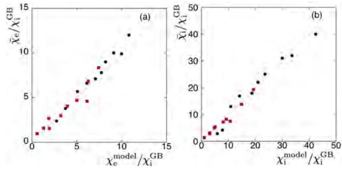
図 3.3.2.1-1 (a) 電子熱拡散係数モデル、(b) イオン熱拡散係数モデルと非線形計算結果の比較
