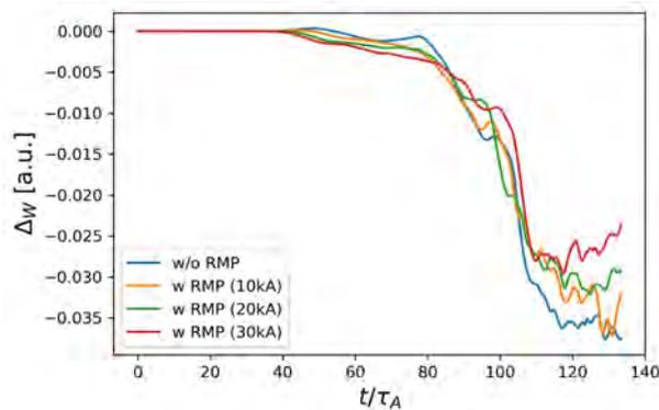
図 4.4.3-2  $n=3$  の偶パリティで誤差磁場補正コイルに電流を流した場合の損失エネルギーの時間発展。20kA 以上の場合で、ELM による損失エネルギーの低減がみられる。
