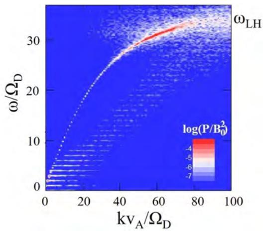
図 3.3.3.2-1 リング状の速度分布を持つ高速イオンによる不安定性に起因する磁場揺動のスペクトル [3.3.3.2-2]
