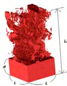
図 3.3.4-9 タングステンファズの実際の構造。ファズは、大野研究室(名大)、吉田氏(名大)、矢嶋氏(NIFS)に作成いただいた。三次元構造は安永氏(九工大)により測定された。サイズは  $L = 202$  nm,  $d = 110$  nm,  $L_z = 530$  nm である。
