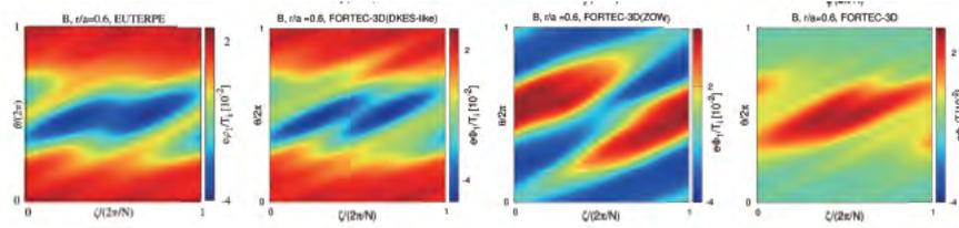
図 3.3.2.8-2 局所近似及びグローバル計算による  $\Phi_1$  ポテンシャル分布の比較。左 から DKES モデルを使った先行研究 [3.3.2.8-9] の結果、LOF3D による DKES モデルと ZOW モデルの結果、FORTEC-3D によるグローバル計算の結果である。径電場としてはローカル近似で求めた両極性電場（負電場）を用いている。
