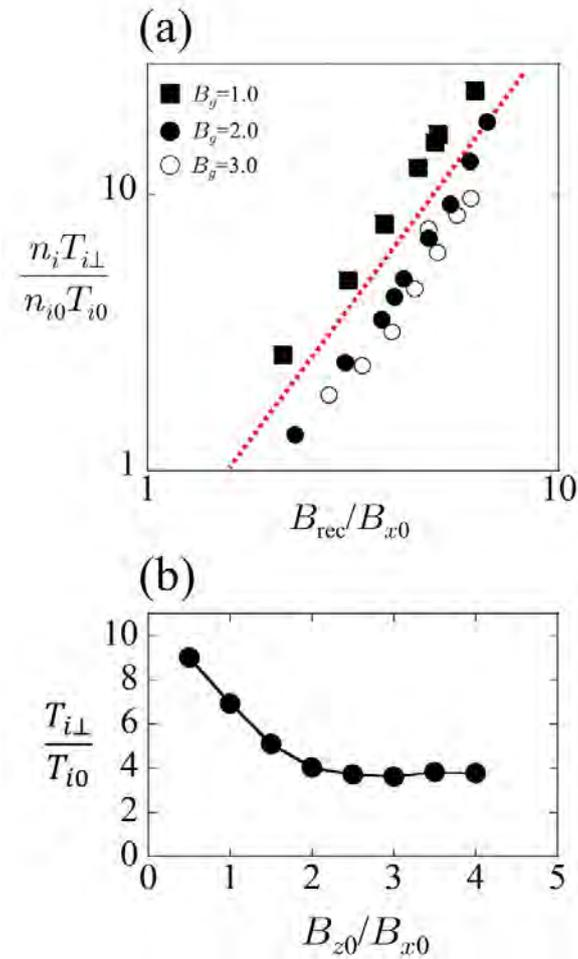
図 3.3.5.6-3 イオン加熱に対する、(a)リコネクション磁場、(b)ガイド磁場、それぞれの依存性。イオン加熱のエネルギーはリコネクション磁場の2乗に比例し、ガイド磁場が強くなるとイオン温度は下がる傾向がある。
