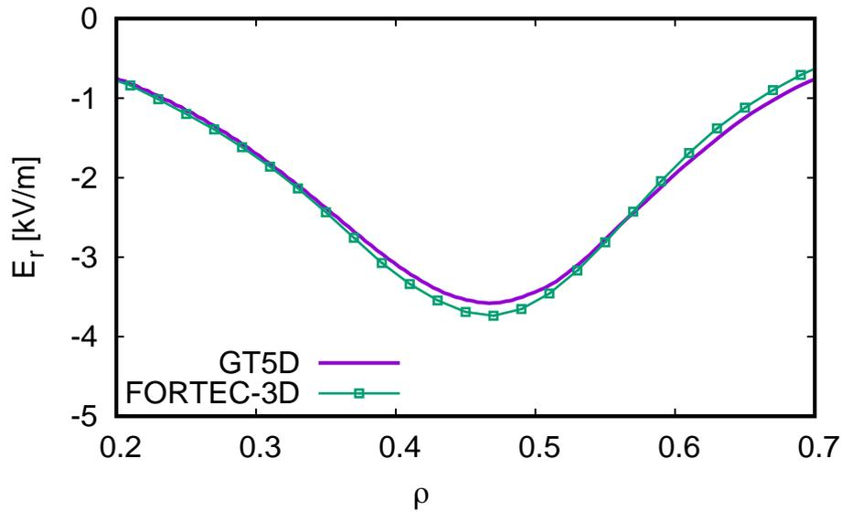
図 3.3.2.6-1 GT5D 及び FORTEC-3D コードで得られた（準）定常径電場分布。新古典輸送の両極性条件から得られた径電場がよく一致している。
