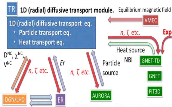
図 3.2.2.2-1 到達パラメータ予測型 TASK3D のモジュールと計算体系概観図。(参考文献 [3.2.2.2-1] より転載)
