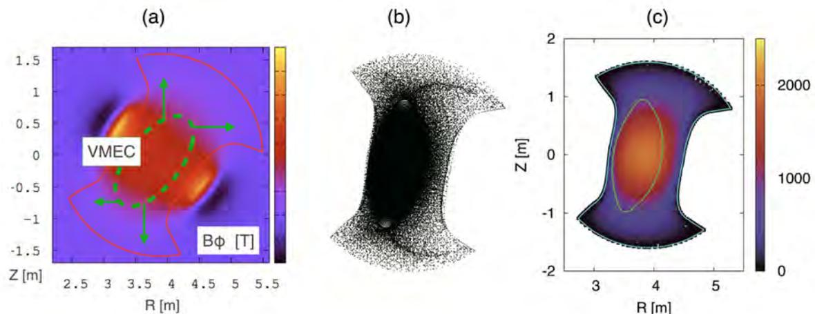
図 3.3.5.4-2 (a) : 周辺領域へ拡張された LHD 平衡の磁場分布。点線内が VMEC 平衡部分。(b) : コア及び周辺領域を統合した非構造三角形格子 (格子点を表示)。(c) : 非構造格子への有限要素法の適用例。接続面 (緑線) によらない滑らかなポテンシャル分布が解として得られている。
