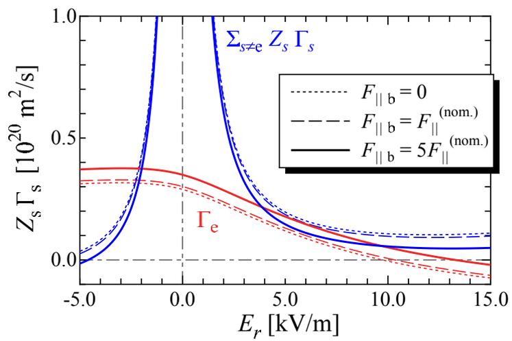
図 3.3.2.8-1 新古典粒子フラックスと径電場の関係。線種は外部トルクの強さを表す。
