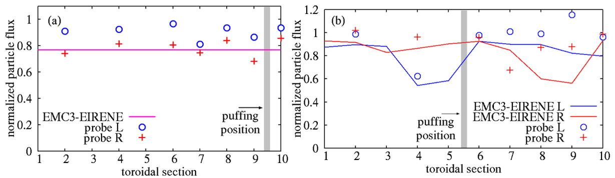
図 3.3.4-2 (a) ネオンパフ放電及び (b) 窒素パフ放電におけるダイバータ粒子束のトロイダル分布の実験と数値モデルの比較。+及び○はプローブで計測された粒子束、実線は数値モデル。赤と青はそれぞれ右側ダイバータと左側ダイバータに相当し、ネオンパフの数値モデルについては、モデルの原理的に左右が同一の値を持つため、区別せず紫で示す。
