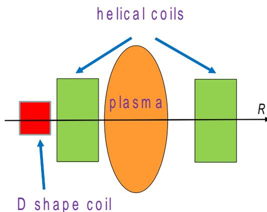
図 3.3.1.9-1 D shape coil とヘリカルコイルの模式図
