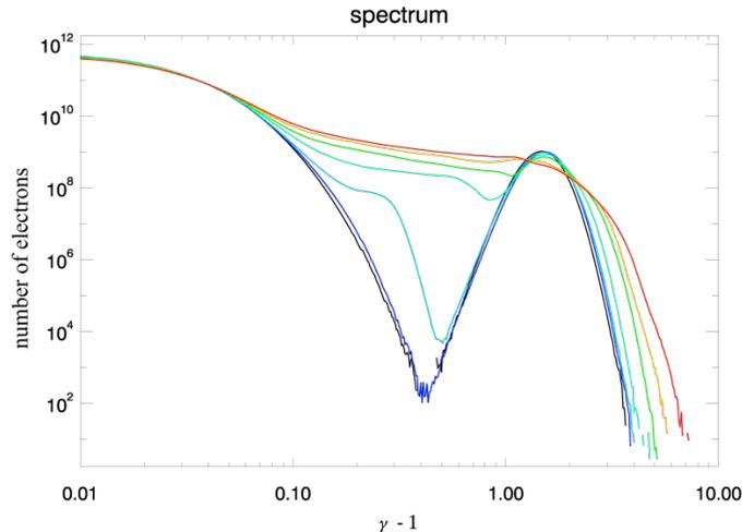
図 4.2.1-2 電子スペクトルの時間発展。初期 (黒線) には Maxwell 分布及び、バルク速度による shifted-Maxwell 分布を示しているが、時間が経過するとマッシュルーム不安定性の成長に伴い磁気リコネクションが発生し、電子が加速されている様子が分かる (時刻  $t = 12.5$  (青色)、20 (水色)、125 (青緑)、250 (緑)、500 (オレンジ)、750 (赤) [ $1/\omega_{pe}$ ])。ここで  $\omega_{pe}$  は電子のプラズマ振動数で、マッシュルーム不安定性の線形成長時間は  $1/\omega_{pe}$  である。
