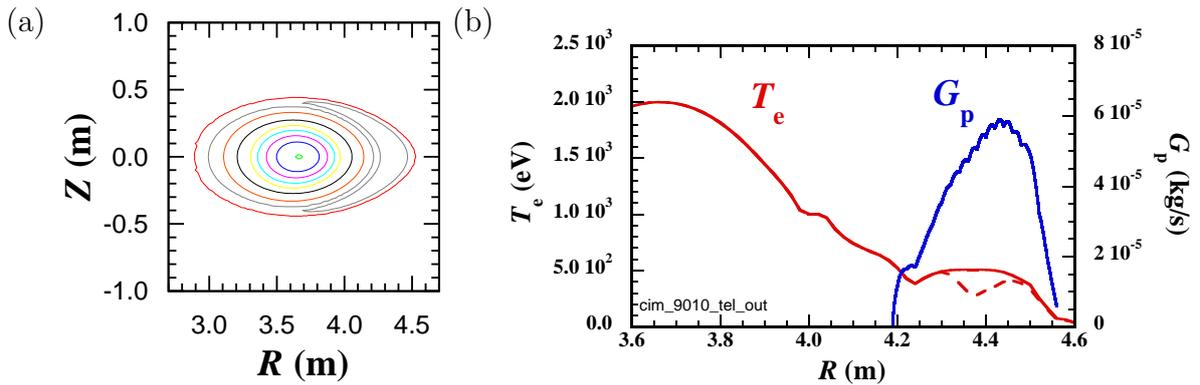
図 3.3.1.10-2 (a)  $m/n = 1/1$  の磁気島がある配位における横長ポロイダル断面。(b) ペレット溶発率  $G_p$  (青線) と電子温度  $T_e$  (赤線)。実線は初期温度、破線はペレット消滅後の温度を示す。
