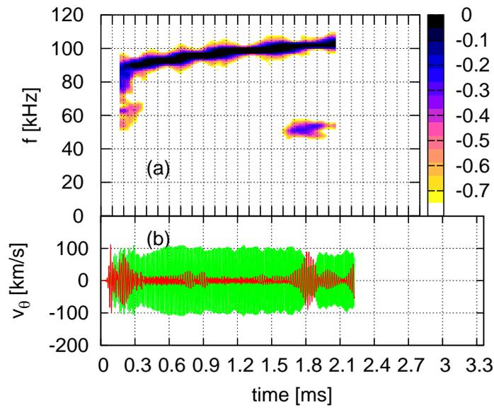
図 3.3.3.1-5 (a) ポロイダル流の周波数スペクトルの時間発展と (b) ポロイダル流の時間発展。パネル (b) では 50kHz の振動が赤、100kHz の振動が緑でそれぞれ示されている。 [3.3.3.1-8]
