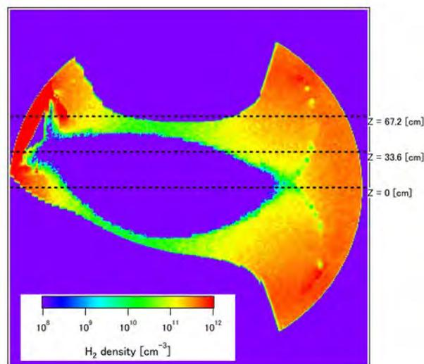
図 3.3.4-8 素分子の振動・回転状態を区別した中性粒子輸送コードにより計算したLHD内の水素分子分布。壁でのソースとして、本課題で開発した炭素壁水素リサイクリングモデルから得た放出粒子の振動状態・回転状態等の情報を取り入れた。また、プラズマ流体コード EMC3 により得られた LHD の電子温度・密度・イオン流などのプラズマ（荷電粒子）の情報も組み込んでいる。
