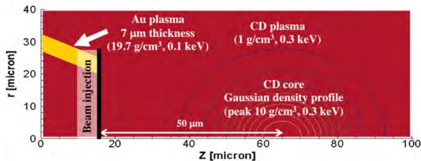
図 3.3.5.8-2 2次元コア加熱 fibmet2 コードで用いた金コーンと爆縮コアのプロファイル及び粒子ビームの入射地点。
