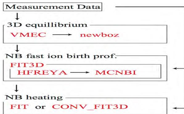
図 3.2.2.1-2 TASK3D-aにおける中性粒子ビーム入射加熱モジュールの計算フロー。
