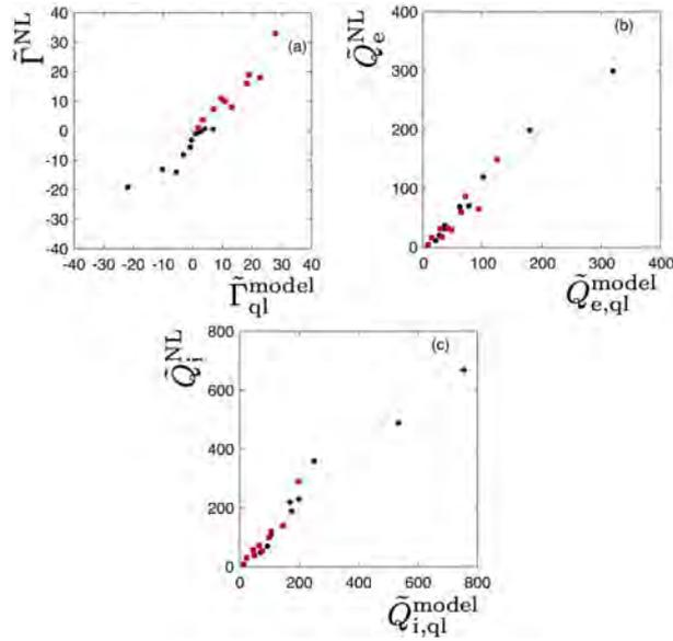
図 3.3.2.1-2 (a) 粒子、(b) 電子熱輸送、(c) イオン熱輸送に関する準線形流束モデルと非線形計算結果の比較
