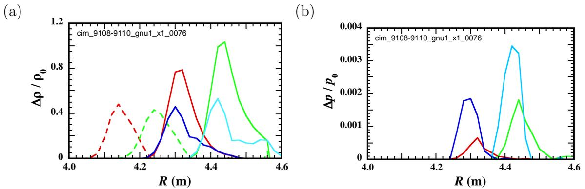
図 3.3.1.10-3 磁気島がない配位とある配位における (a) 密度分布と (b) 圧力分布。赤線、緑線はそれぞれ磁気島がない配位とある配位の値を示し、実線と破線はそれぞれ  $t = 15\mu\text{s}$  と  $35\mu\text{s}$  における値を示す。また、青線と水色線はそれぞれ、赤線、緑線の熱伝導のない場合に対応する。
