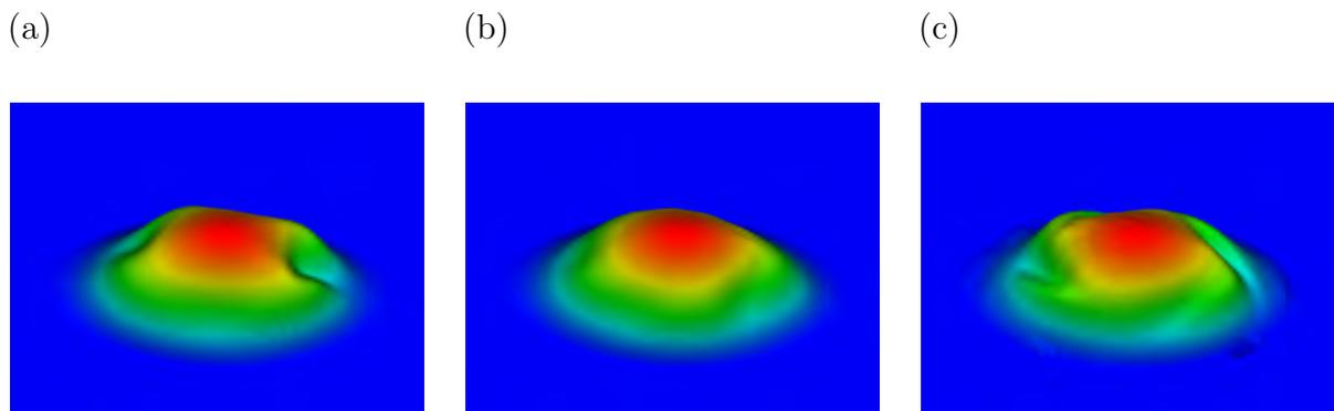
図 3.3.1.3-1 交換型モードによって変形した圧力分布の鳥観図。(a) フローなしの場合、(b) 実験値の 10 倍のフローが存在する場合、(c) 実験値の 30 倍のフローが存在する場合。
