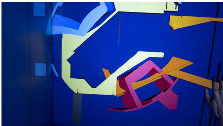
図 3.3.5.10-1 ヘリカル型原型炉のVR可視化。パーツを仮想的な「手」でつかみ、つかんだパーツが別のパーツと接触したため赤く表示されている。
