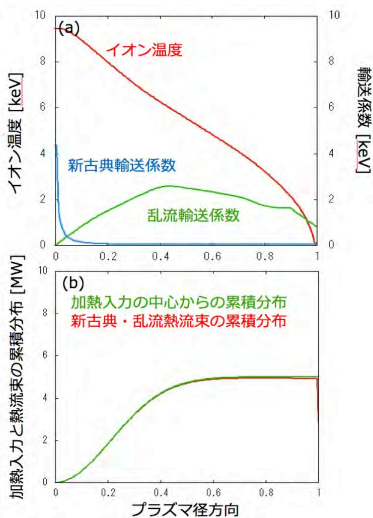
図 3.3.2.2-1 (a) 定常パワーバランス状態におけるイオン温度分布 (赤線)、新古典輸送係数(青線)、及びGKVが予測した乱流輸送係数 (緑線)。(b)最終時刻における加熱入力とプラズマ自身が駆動する熱流束の累積分布の比較。
