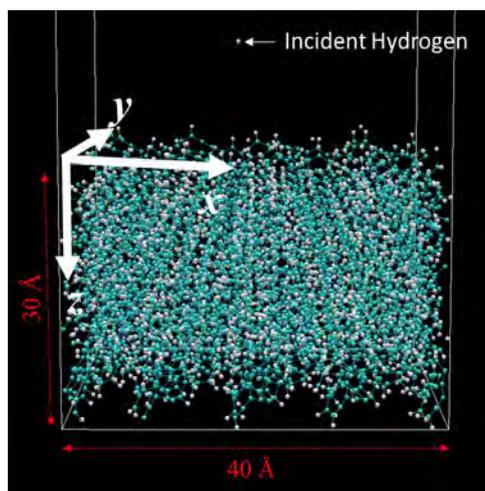
図 3.3.4-6 炭素壁水素リサイクリングモデルとして計算した分子動力学計算の系
