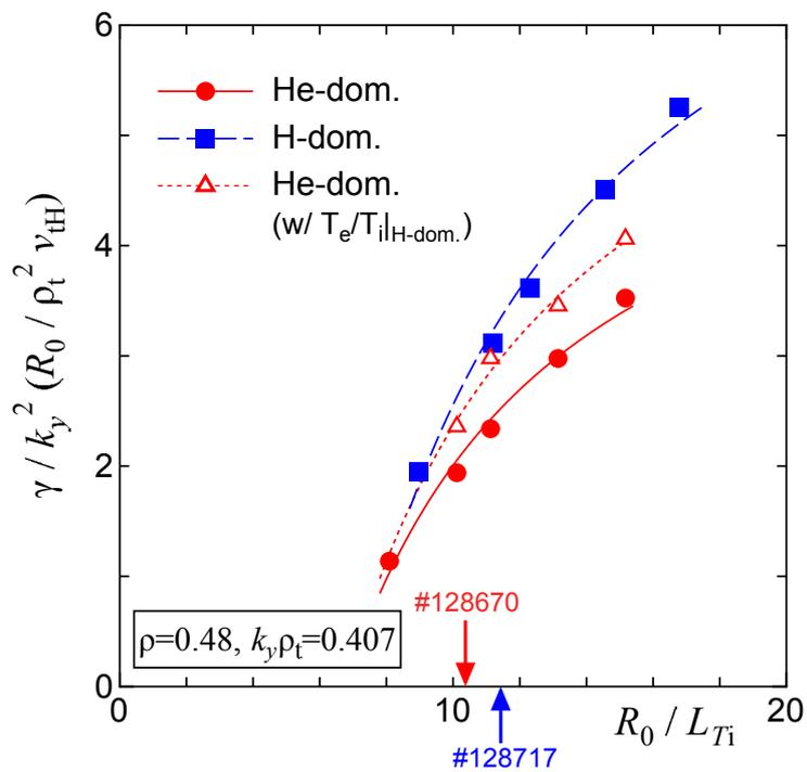
図 3.3.2.4-1 LHD プラズマにおける熱輸送係数の混合長解析。赤実線がヘリウムイオン過多、青破線が水素イオン過多の場合を示し、赤点線は、水素イオン過多での電子・イオン温度比をヘリウム過多プラズマに適用した結果。
