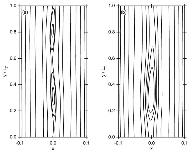
図 3.3.1.4-2 (a) インターチェンジパリティモードの振幅が最も大きい初期の飽和状態 ( $t = 40000$ ) における磁気面と、(b) 変調不安定性により成長したテアリングパリティモードが飽和状態 ( $t = 150000$ ) にある時の磁気面。
