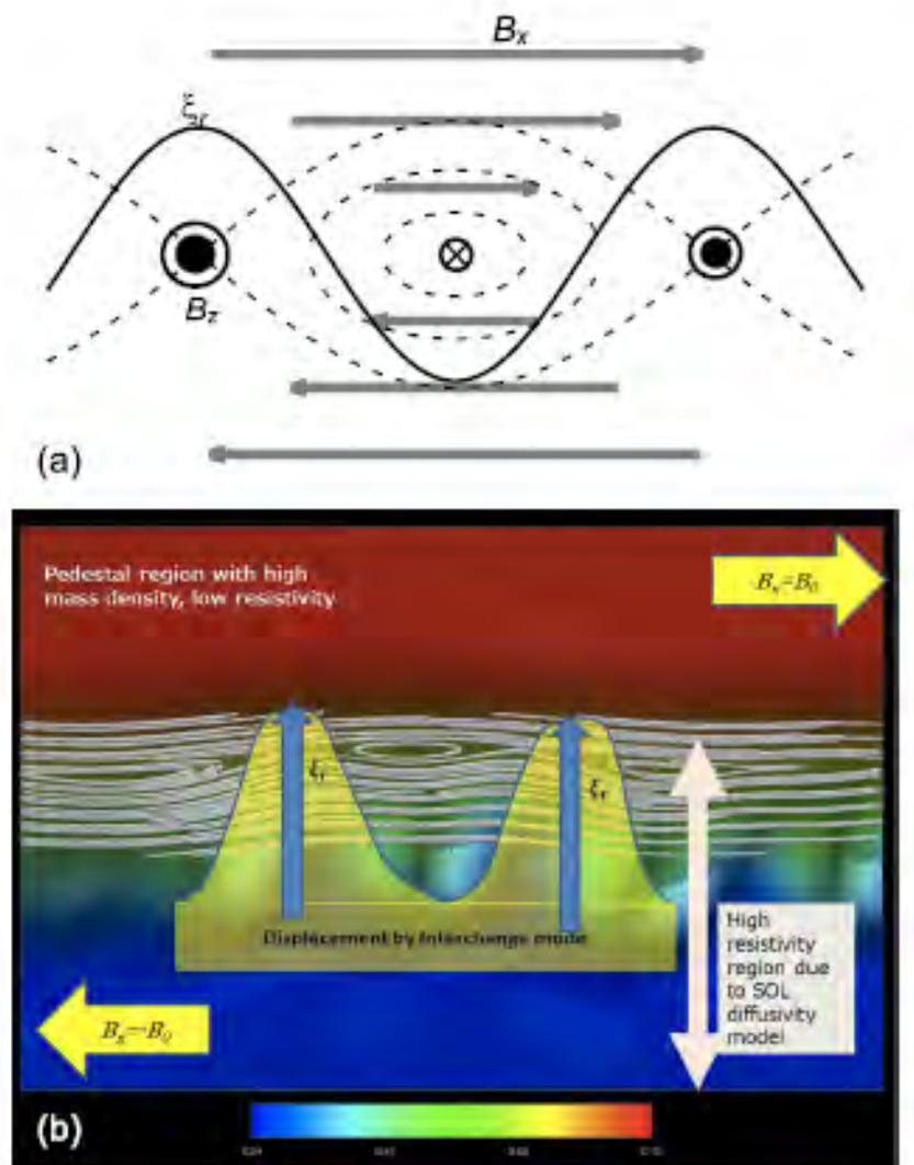
図 3.3.5.2-1 Fig: (a) CITM の模式図。(b) 磁力線 (太い白線) 及び模式的に描かれたプラズマ変位、並びにプラズマの等高線 (カラーマップ)。(文献[3.3.5.2-1] 図 5 より。)
