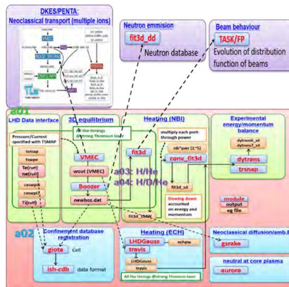
図 3.2.2.1-1 LHD 実験データ解析型 (TASK3D-a シリーズ) の機能拡張の進展。中央部横一列で示された a01 版から、下段に記された機能拡張 (a02 版)、NBI 加熱モジュールを中心とした複数イオン種 (軽水素、ヘリウム、重水素) 対応 (a03、a04)、さらに、複数イオン種の新古典輸送解析に関する大規模シミュレーションコードとの連携や高エネルギー粒子挙動に関する機能拡張 (上段部) などの進展を遂げている。(参考文献 [3.2.2.1-2] より転載)
