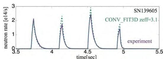
図 3.2.2.1-4 中性子発生率の時間変化。実線が計測結果、点線が計算結果である。計算には、図 3.2.2.1-3 に示した計測結果と計算結果の差から推定される実効的な高速イオン閉じ込め時間と有効電荷数を用いた。(参考文献3.2.2.1-2] より転載)
