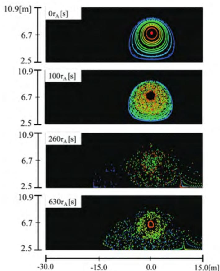
図 4.1.3.7-2 ST プラズマへの小型トーラスプラズマ移送合体の3次元MHDシミュレーションにおける、初期分布 ( $0 \tau_A$ )、外部コイル立ち上げ完了 ( $100 \tau_A$ )、プラズマの衝突 ( $260 \tau_A$ )、プラズマの合体直後 ( $630 \tau_A$ ) でのポアンカレマッピング。色が赤に近いほど開始点がプラズマ中心に近い。
