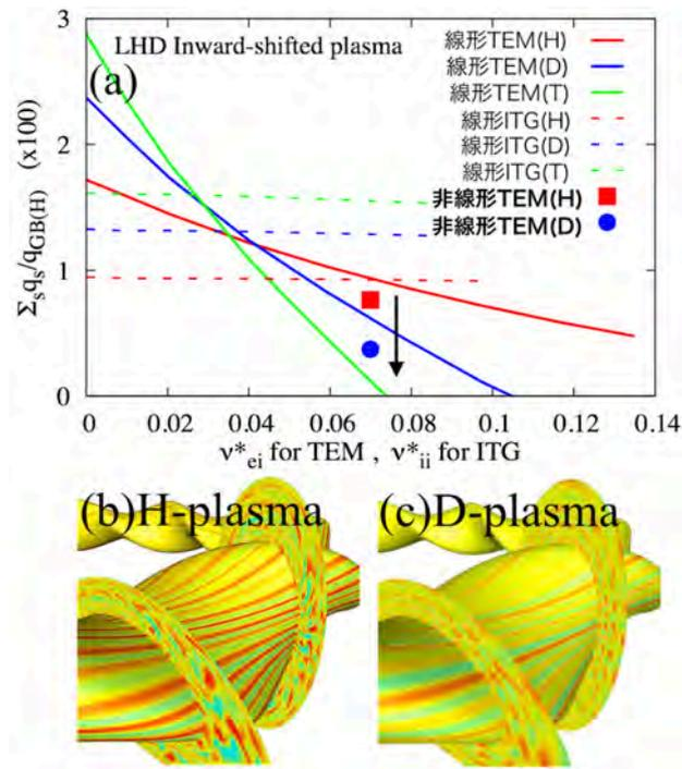
図 3.3.2.5-1 (a)LHD における乱流熱輸送の同位体質量及び衝突度依存性。(b)及び (c) 乱流場構造の比較
