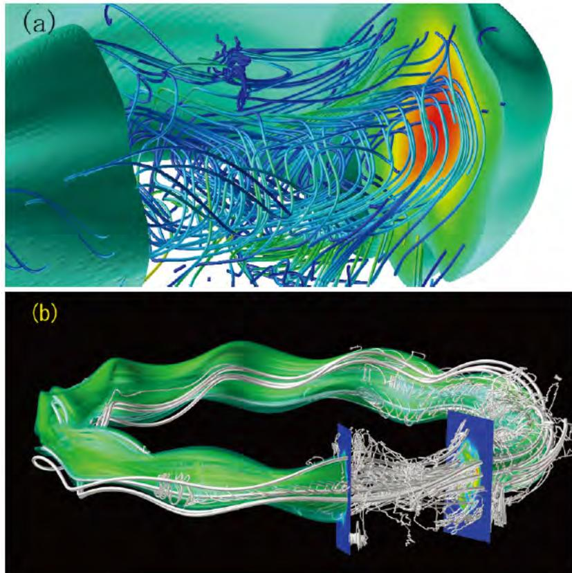
図 3.3.1.7-1 (a) LES の不安定性の線形段階終盤における、圧力の等値面との流線。
