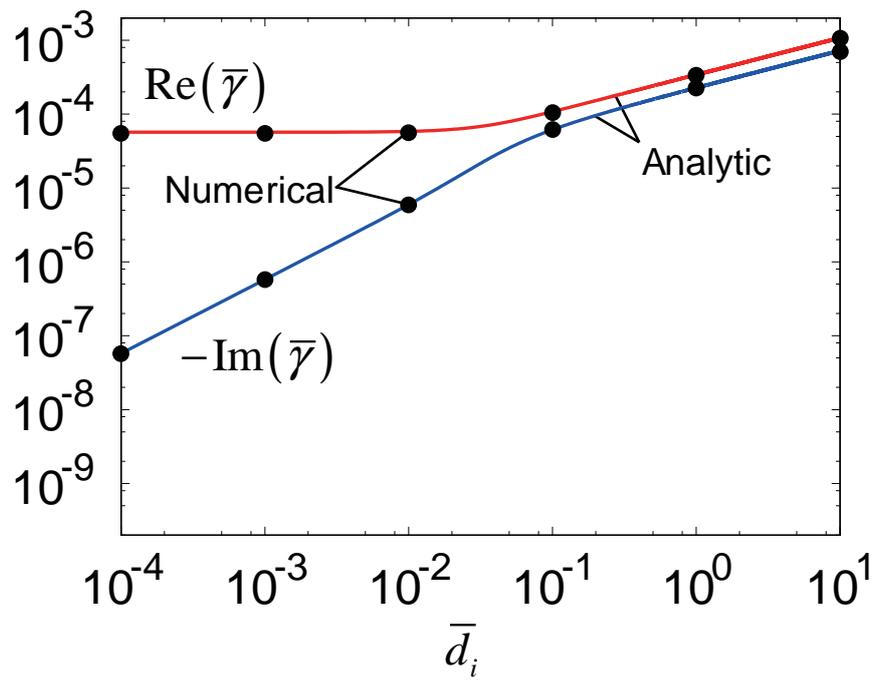
図 3.3.5.3-1 円柱プラズマにおける二流体テアリングモードの成長率と実周波数のイオンスキン長依存性（線は解析解、点は数値解）
