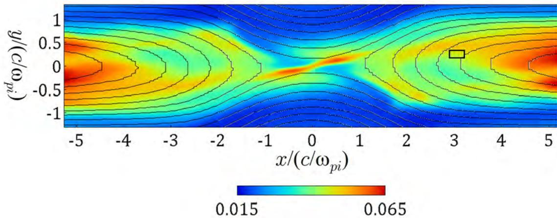
図 3.3.5.6-1 PASMO コードによる磁気リコネクションのシミュレーション結果。カラーコンターは磁場に垂直なイオン温度、線は磁力線を表している。
