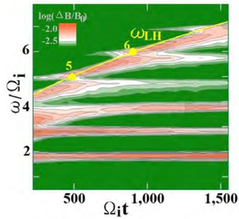
図 3.3.3.2-2 密度が増加しているプラズマ中にピッチ角の小さい高速イオンを注入し続けた場合の、磁場揺動の周波数の時間変化 [3.3.3.2-3]
