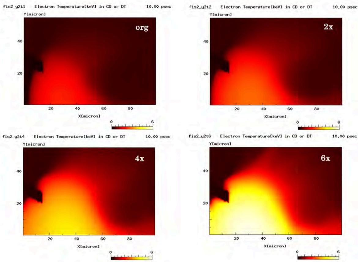
図 3.3.5.8-4  $t=10\text{ps}$  における 4 つのケースの電子温度分布。単位は  $\text{keV}$ 。
