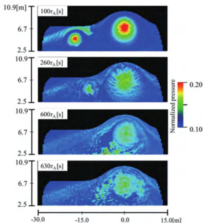
図 4.1.3.7-1 ST プラズマへの小型トーラスプラズマ移送合体の 3次元 MHD シミュレーションにおける、外部コイル立ち上げ完了 ( $100 \tau_A$ )、プラズマの衝突 ( $260 \tau_A$ )、プラズマの合体直前 ( $600 \tau_A$ )、プラズマの合体直後 ( $630 \tau_A$ ) の各時点の  $\theta = 0$  ポロイダル面の圧力及びポロイダル磁束の等値線分布。
