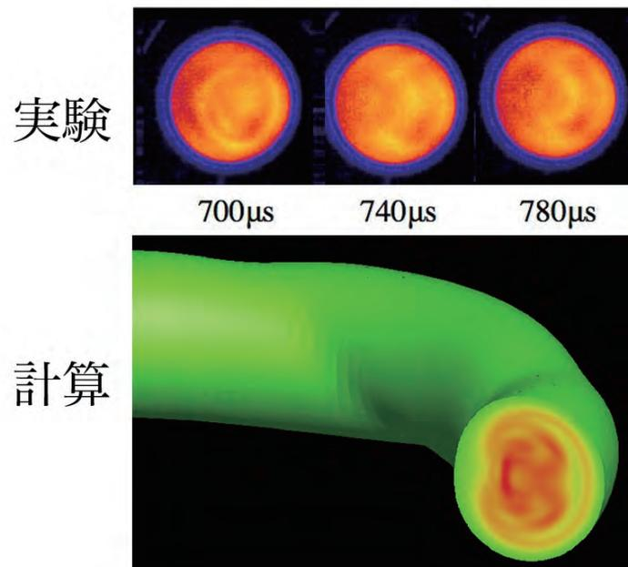
図 4.1.3.4-1 RFP の QSH 状態形成時に現れる特徴的な圧力分布（上:RELAX 装置における SXR 計測結果、下:MIPS によるシミュレーション結果）
