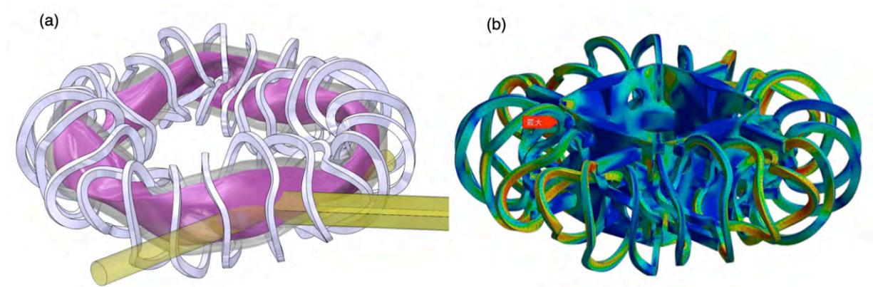
図 6.2.4-1 トライアル配位を用いた模擬工学設計: (a) 加熱・計測ポートの配置検討、(b) 支持構造設計と ANSYS-MAXWELL を用いた電磁応力解析
