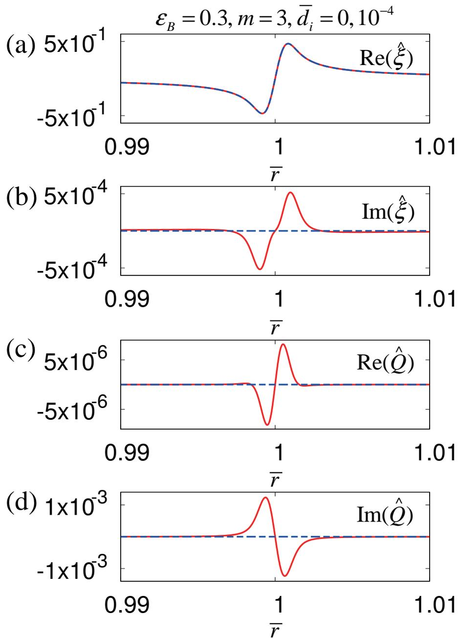
図 3.3.5.3-2 円柱プラズマにおける二流体テアリングモードの固有関数 (点線は  $\bar{d}_i = 0$ 、実線は  $\bar{d}_i = 10^{-4}$ )
