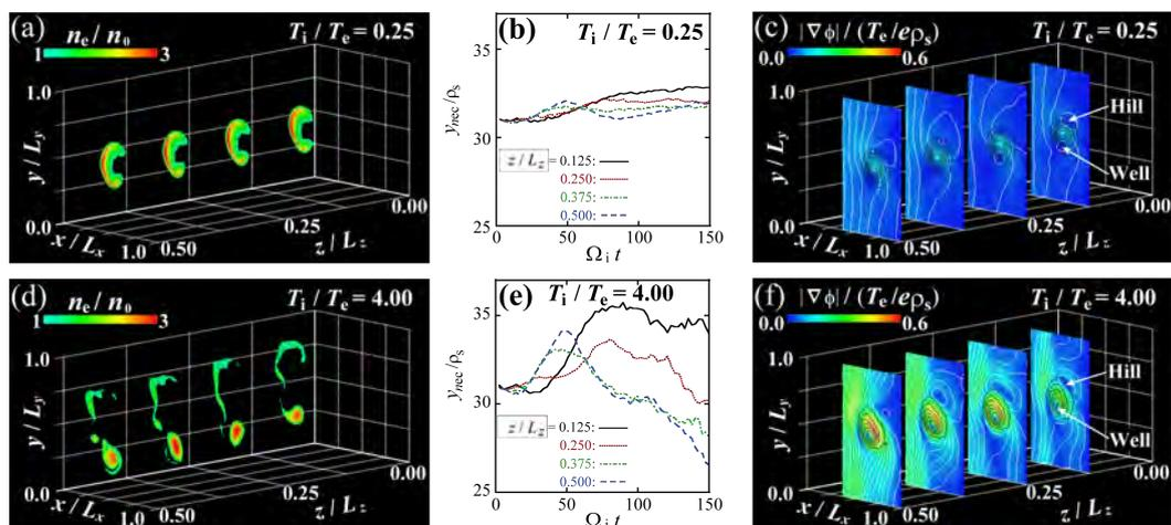
図 3.3.5.5-1 異なる4つの断面における電子の密度分布 [(a)、(d)]、各断面における電子重心位置の  $y$ （ポロイダル）方向の時間変化 [(b)、(e)]、各断面における磁場と垂直方向の電場の強度分布 [(c)、(f)]。上段 [(a) - (c)] が低イオン温度の時、下段 [(d) - (f)] が高イオン温度の時を、それぞれ示している。各図から、高イオン温度の場合には、強い  $z$ （磁力線）方向依存性があることが分かる。
