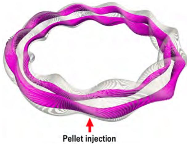
図 3.3.4-3 水素ペレット入射の溶発により形成されたペレットクラウド。  $m/n = 2/1$  の構造を持ってプラズマ中に現れる。
