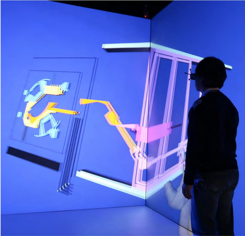
図 2.2.2.2-1 ヘリカル型原型炉の設計データをバーチャルリアリティ装置 CompleXcope に投影して、ロボットアームによる炉内部品の取り外しを確認している様子。
