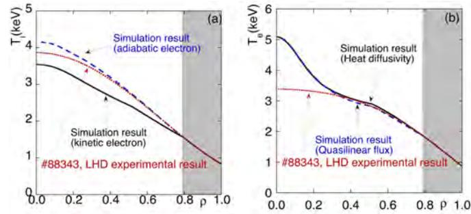
図 3.3.2.1-3 (a) イオン温度分布、(b) 電子温度分布と LHD 実験結果の比較
