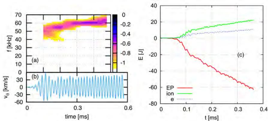
図 3.3.3.1-6 (a) ポロイダル流の周波数スペクトルの時間発展、(b) ポロイダル流の時間発展、(c) 高エネルギー粒子 (赤)、熱イオン (緑)、電子 (青) のエネルギーの時間発展。 [3.3.3.1-9]
