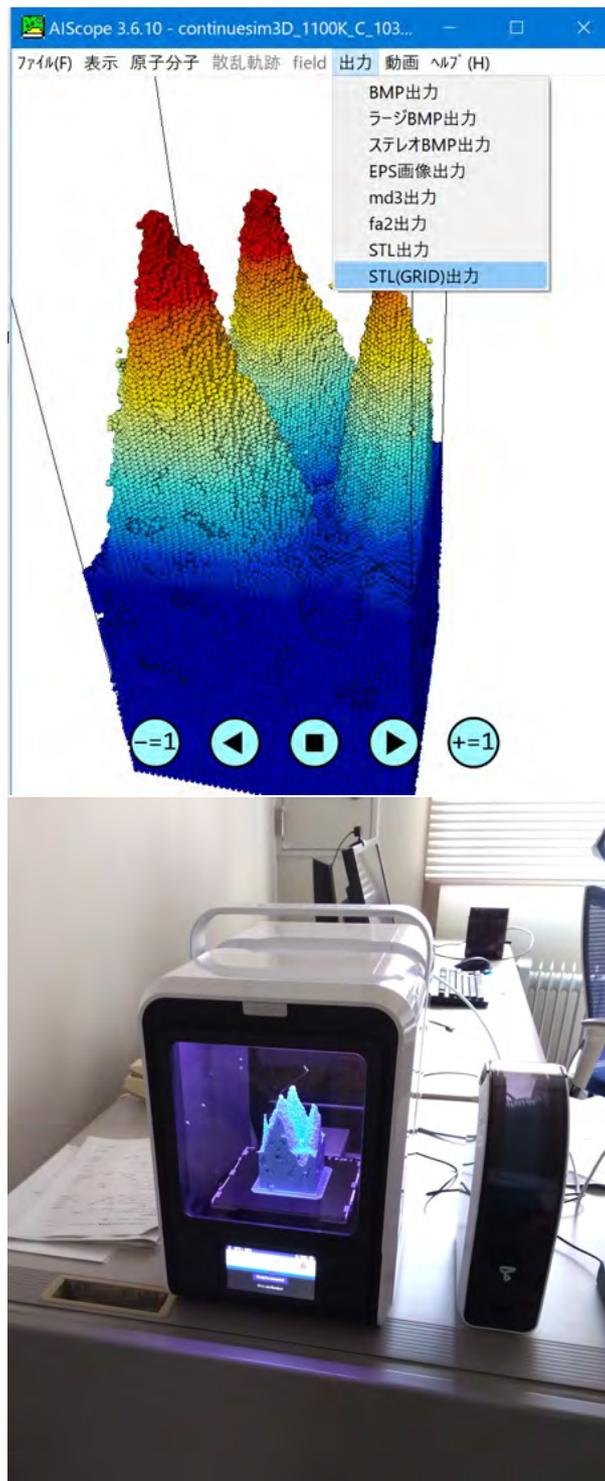
図 3.3.4-5 BCA-MD-KMC 三連ハイブリッド計算によって生えてきたタングステン表面のファズ構造。(a) 本プロジェクトで開発している可視化ソフト AIScope で可視化し、(b) 本ソフトを通して 3D プリンティングしている様子。
