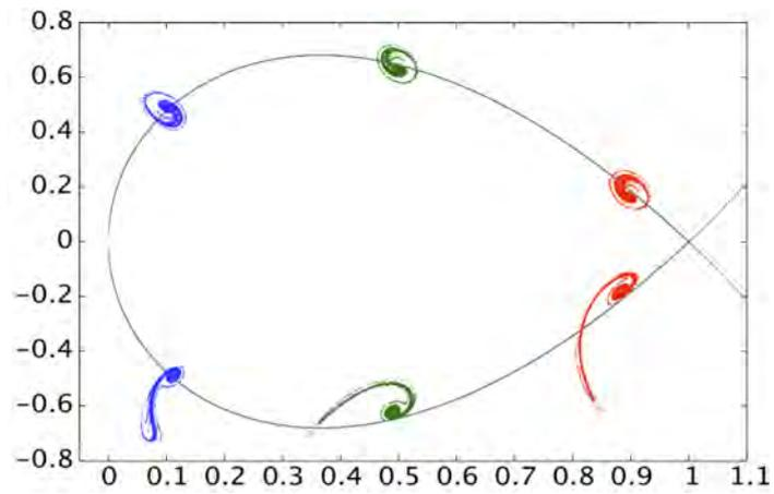
(a) ポアンカレ断面。縦軸と横軸は4次元位相空間から選んだ2次元方向を表す。
