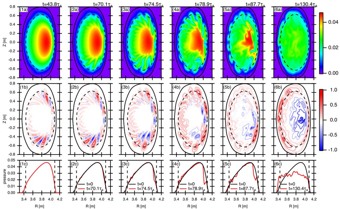
図 3.3.1.5-1 ポロイダル断面における（上段）全圧力分布と（中段）圧力の揺動成分の時間発展の様子。下段は、同断面における  $Z = 0$  上での全圧力分布の時間発展を示している。
