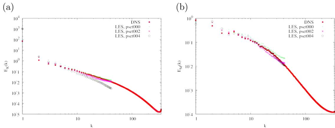
図 3.3.5.1-1 一様磁場  $B_0 = 5$  が印加された一様 Hall MHD 乱流の DNS 及び LES における (a) 運動エネルギースペクトル  $E_K(k)$  及び (b) 磁気エネルギースペクトル  $E_M(k)$ 。
