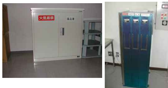
危険物保管庫
