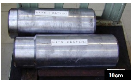
図 2. 4. 2-1 核融合科学研究所で製作した 167kg の高純度バナジウム合金インゴット
