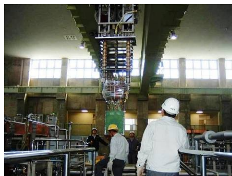
図 2.4.1-3 SST-1 用 CIC 導体サンプルと大型導体試験装置への組み込み時の写真
