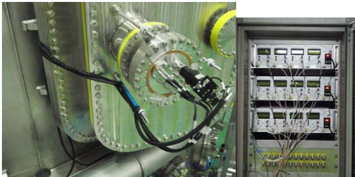
図 3.1.2-1 (a) 抵抗性ボロメータ導入部 (b) 抵抗性ボロメータの増幅器及び制御回路
