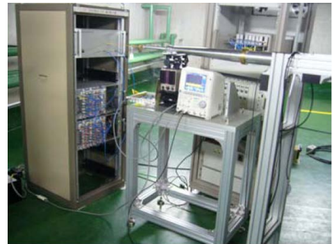
図 3.1.2-2 KSTAR装置に取り付けたヘテロダインラジオメータ装置
