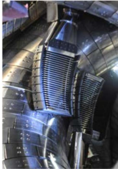
図 4.1.2.3-2 LHD に設置した波数制御 (HAS) アンテナ。
