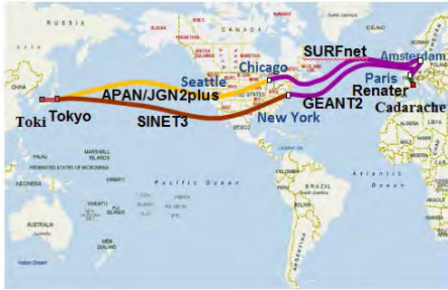
図 5.2-5 データ転送試験のネットワーク経路。経路の大部分は10Gbpsの帯域を有し、SINET3共用回線(SINET3)と専用回線(APAN/JGN2plus)を用いた。
