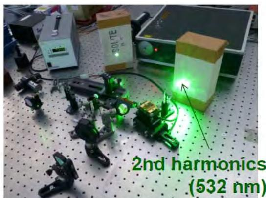
図 3.9.2-3 Nd:YAGレーザーとPPMgSLTを用いた2倍高調波発生試験
