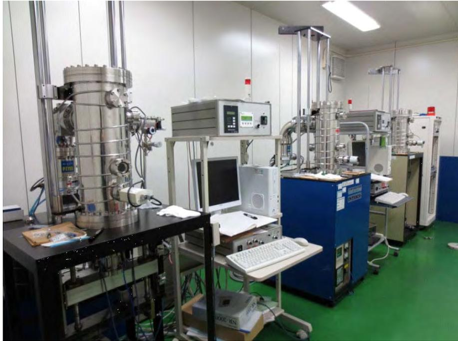
図 2.3.2-1 高温クリープ試験装置(手前が 2010 年導入の 3 号機)。
