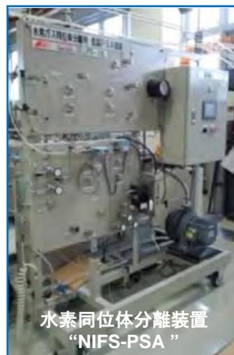
図 4.1-5 システム・環境安全研究分野の一般共同研究で開発された、多塔式圧カスイング低温吸着法水素同位体分離システム
