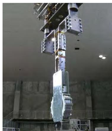
図3.3.1-4 5 kA@12 T級LTS間接冷却導体を用いて製作した3ターンコイル形状サンプルの写真。
