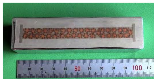
図3.3.1-9 100 kA@12 T級LTS間接冷却導体の試作サンプル。
