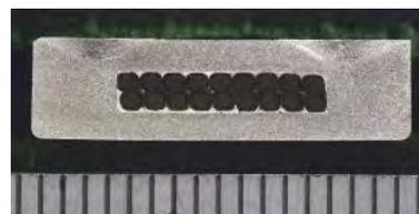
図3.3.1-3 5 kA@12 T級LTS間接冷却導体の断面図(上)と断面写真(下)。
