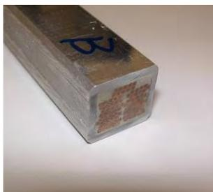
図3.3.1-8 20 kA@12 T級LTS間接冷却導体の写真。
