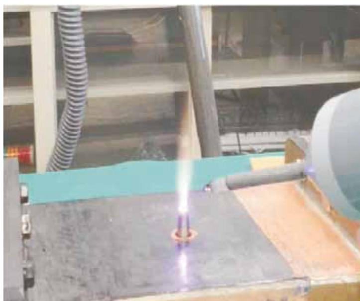
図 4.1.3.10-1 構築したプラズマジェット発生装置(写真はヘリウムプラズマ)
