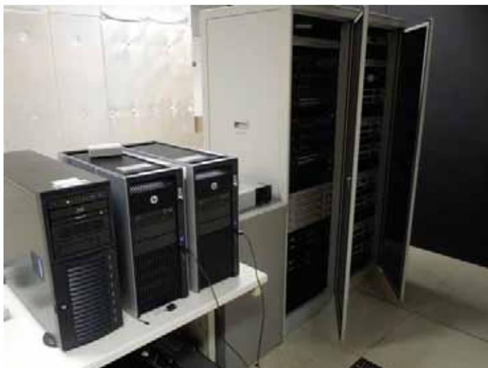
図 2.3.3-1 更新されたバーチャルリアリティ実現用のコンピュータシステム。手前から Linux システム、PC クラスタシステム (2 台) である。奥のラックは 3 次元音響システムである。
