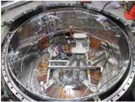
図 4.4.4-3 強制冷却試験装置へのコイル設置作業の様子 (左図:モデルコイル、右図:モジュールコイル)
