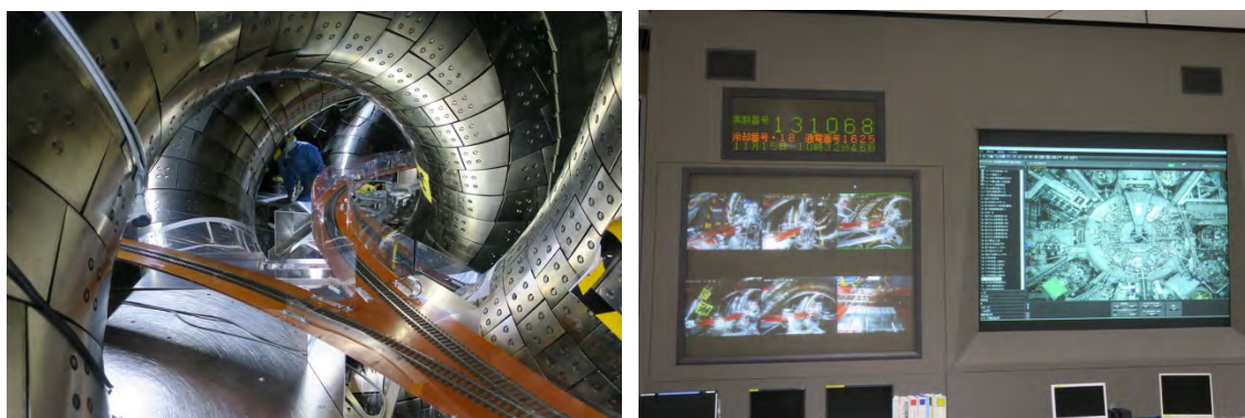
図 3.3.1.1-2 2016年11月に実施したNFMその場校正の様子。(左図)LHD真空容器内に敷設されたレール、(右図)NFMその場校正実験時における制御室の様子
