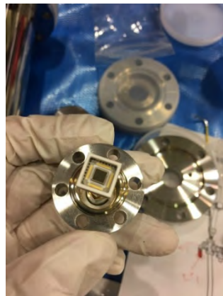
図 3.3.1.2-2 LHD重水素実験に新たに導入されたシングルクリスタルCVDダイヤモンド検出器
