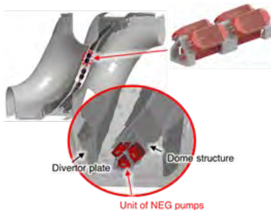
図 3.1.1-4 ダイバータ内に設置された NEG ポンプ
