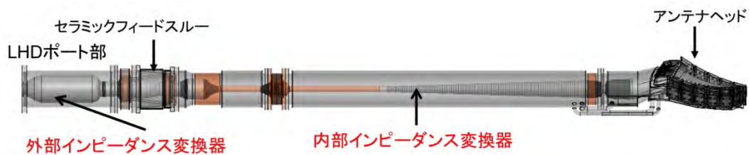
図 3.2.3-2 アンテナ断面模式図
